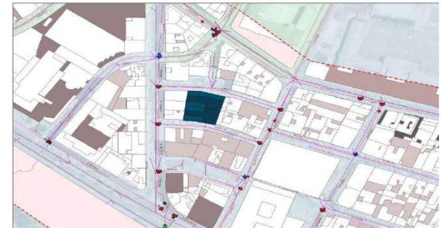
Figura 101. Sistema de alcantarillado, red pública y sentido de recolección.
