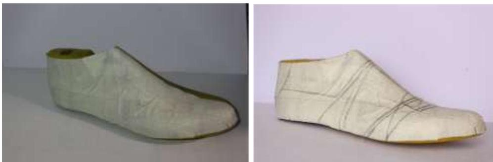
*Figura 136, Dibujo del diseño sobre la horma.*
