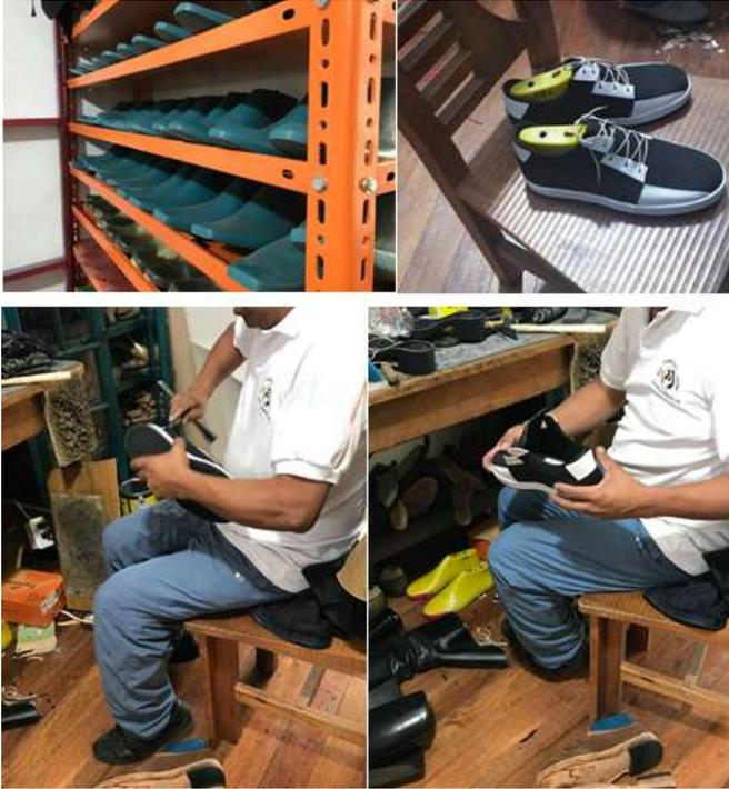
*Figura 170, Desmoldado de la horma Propuesta Final.*
