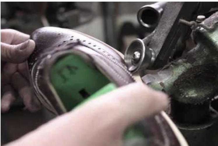
*Figura 15.* Desmoldado de la horma.
