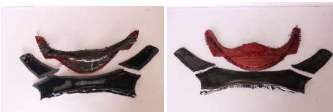
*Figura 84, Desarmado talonera superior zapato Nike.*
