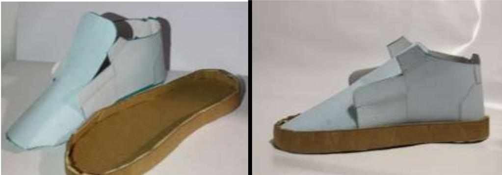
*Figura 141, Pegado de la suela del prototipo.*
