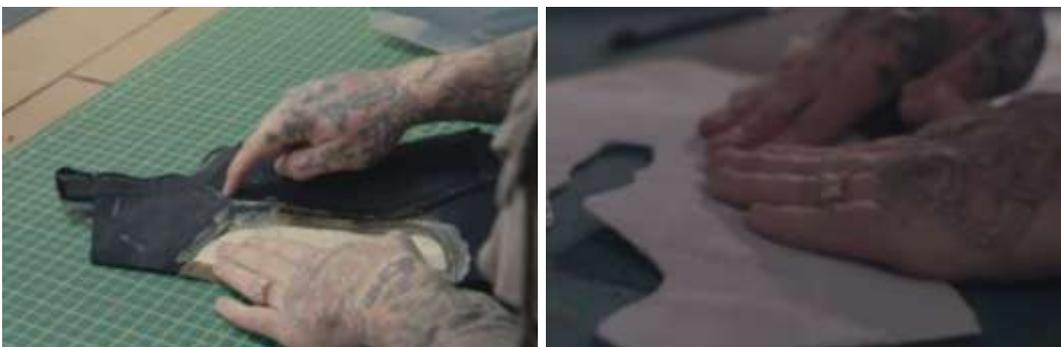
*Figura 43.* Separación de plantillas.
