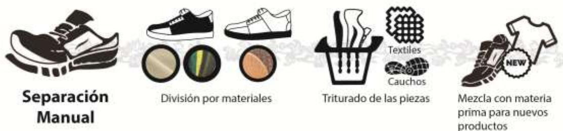
Figura 23, Diagrama de Separación Manual para el reciclaje.
