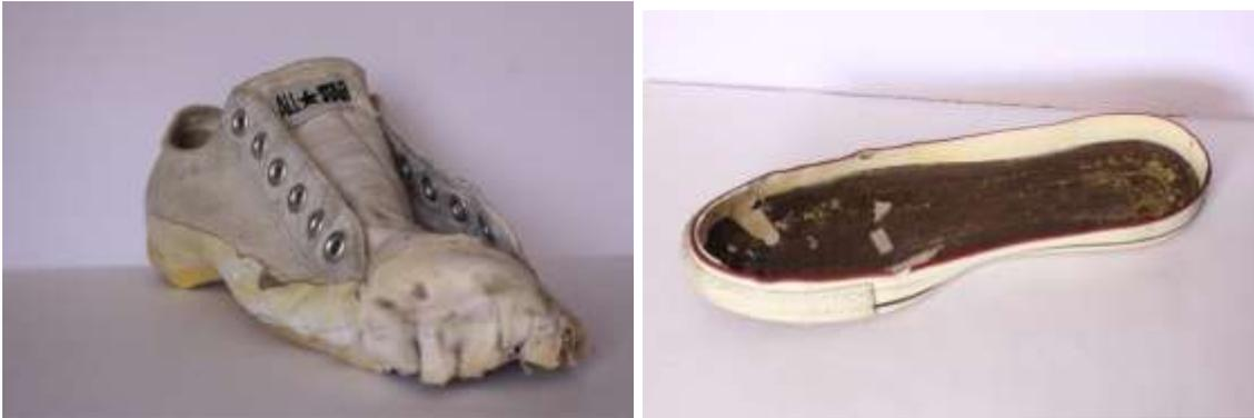
*Figura 71, Separación de la suela zapato Converse.*
