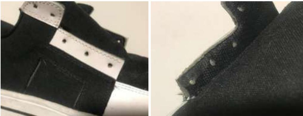
*Figura 191, Fallos de armado esquinas ojaletes.*
