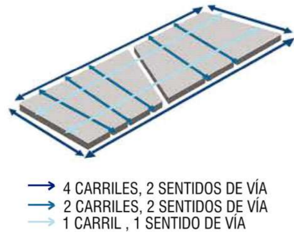
Figura 22. Reestructuración de vías.
