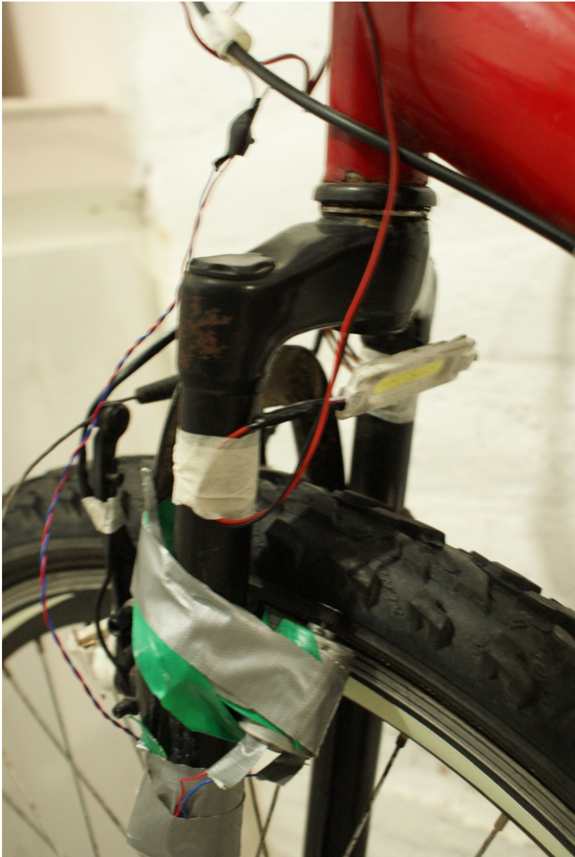
Figura 176. Montaje de sistema electrónico (Rueda Frontal)
