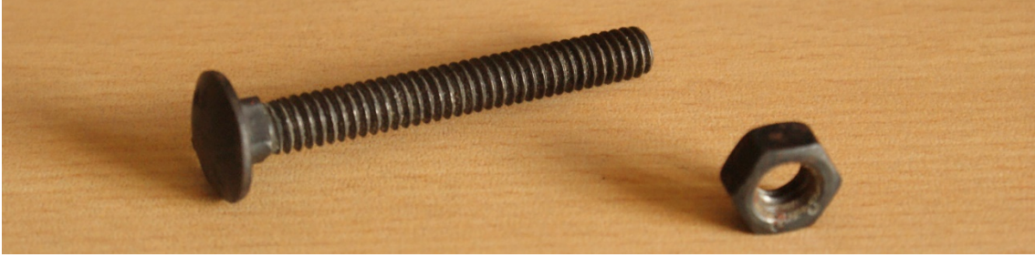
Figura 88. Tuerca y perno (Núcleo de Válvula Solenoide)
