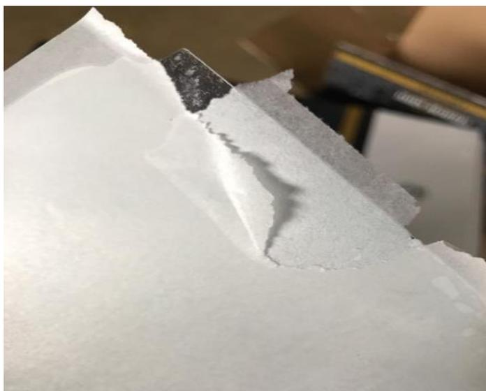
*Figura 25.* Troquelado insuficiente.
