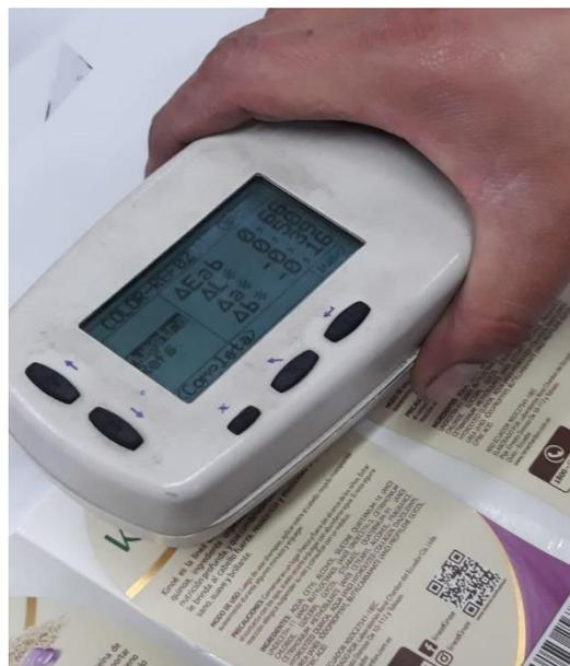
Figura 51. Medición de desviación de color. Impresión aprobada, inferior a los 4 puntos de tolerancia  $\Delta E$ .
