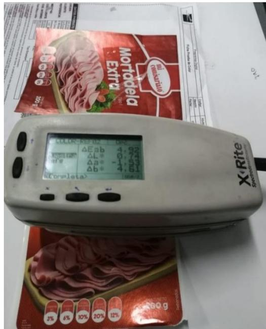
Figura 50. Medición de desviación de color. Impresión rechazada, supera los 4 puntos de tolerancia  $\Delta E$ .
