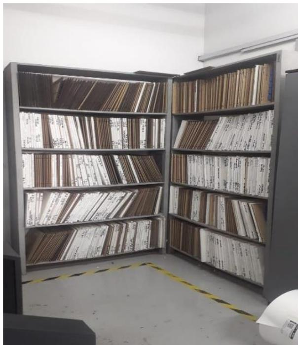
*Figura 56.* Almacenamiento de planchas de troquel, posterior a la implementación de la herramienta de calidad 5'S.
