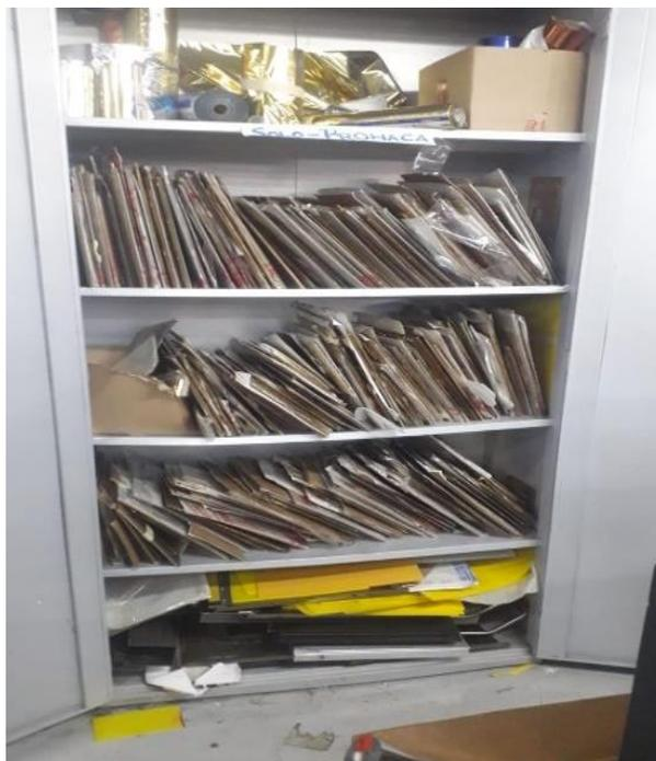
*Figura 55.* Almacenamiento de planchas de troquel, previo a la implementación de la herramienta de calidad 5'S.
