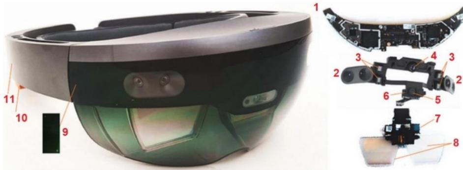
*Figura 13. Componentes de hardware HoloLens.*
