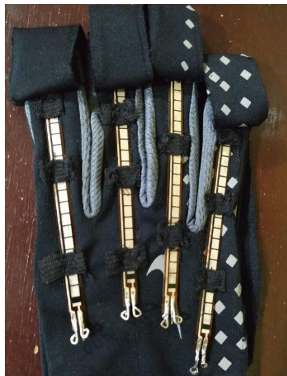
Figura 55. Sujeción sensores cinta elástica.
