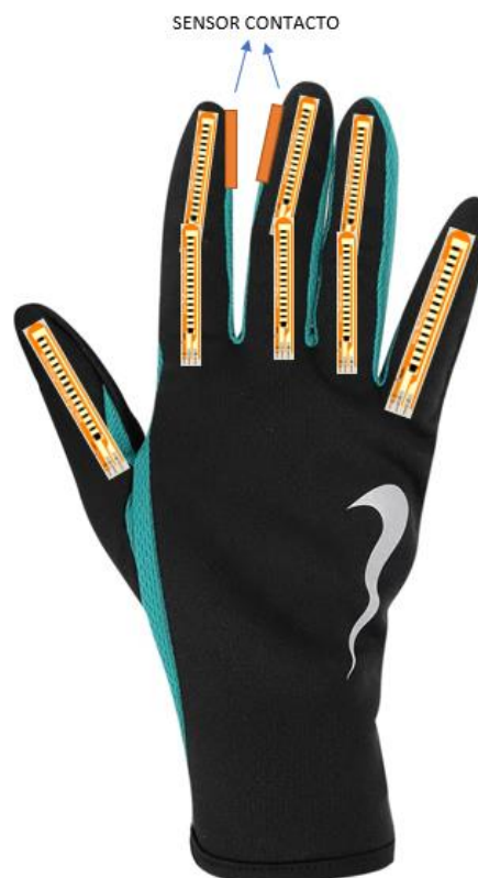
Figura 40. Disposición sensores Prototipo III
