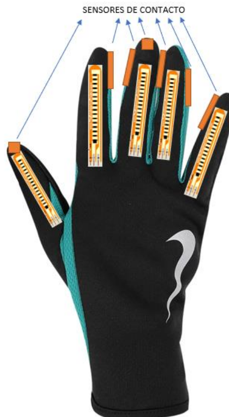
Figura 41. Disposición de sensores Prototipo IV
