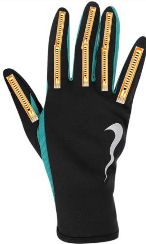
Figura 39. Disposición Sensores Flex
