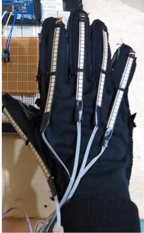
Figura 53. Sujeción sensores con hilo.
