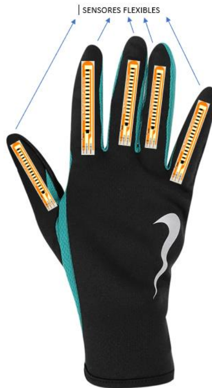
Figura 38. Disposición sensores flex.
