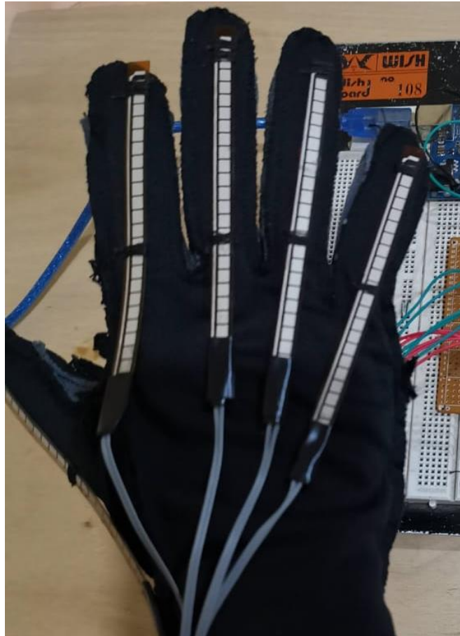
Figura 52. Prototipo guante nylon.
