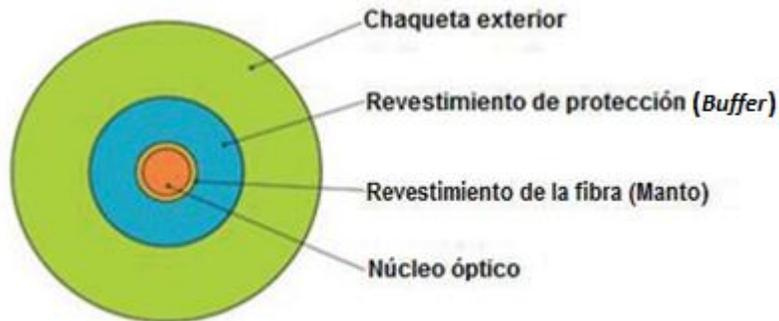
*Figura 8* .Estructura de la fibra óptica.
