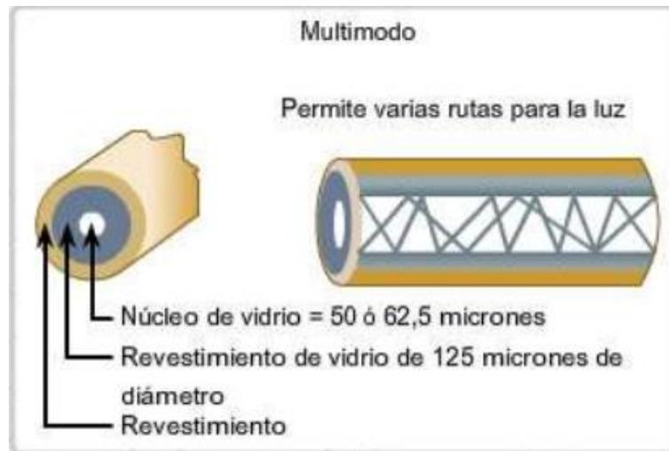
Figura 10. Fibra óptica multimodo.
