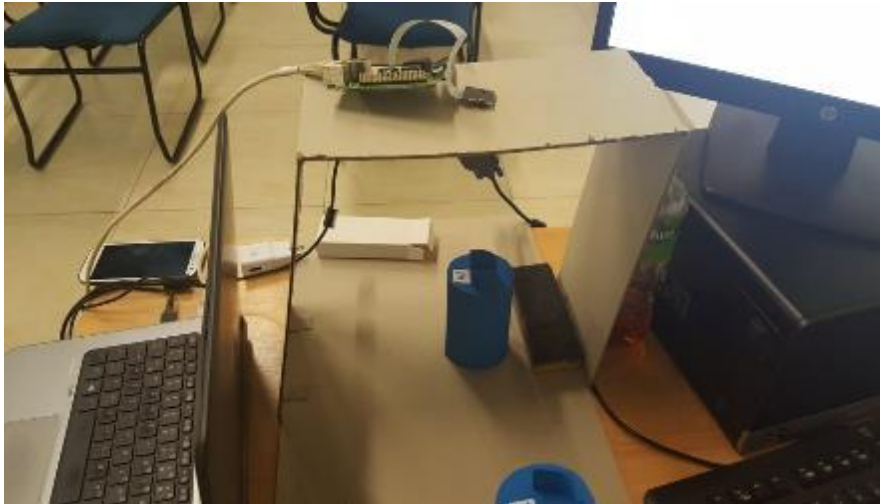
Figura 53. Raspberry Detectando Cilindro a escala color azul
