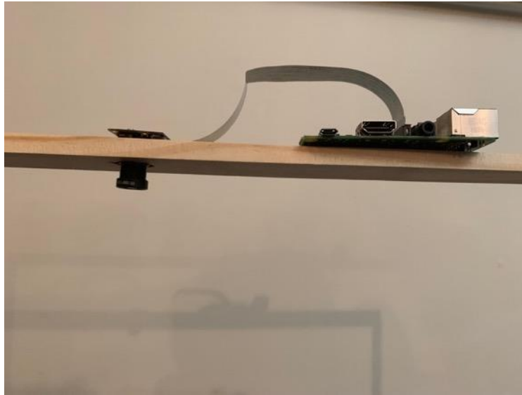
Figura 44. Raspberry Pi con cámara Pi
