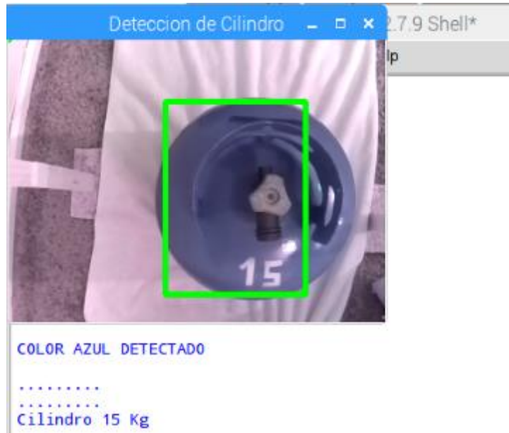
Figura 55. Detección de Cilindro azul con programa
