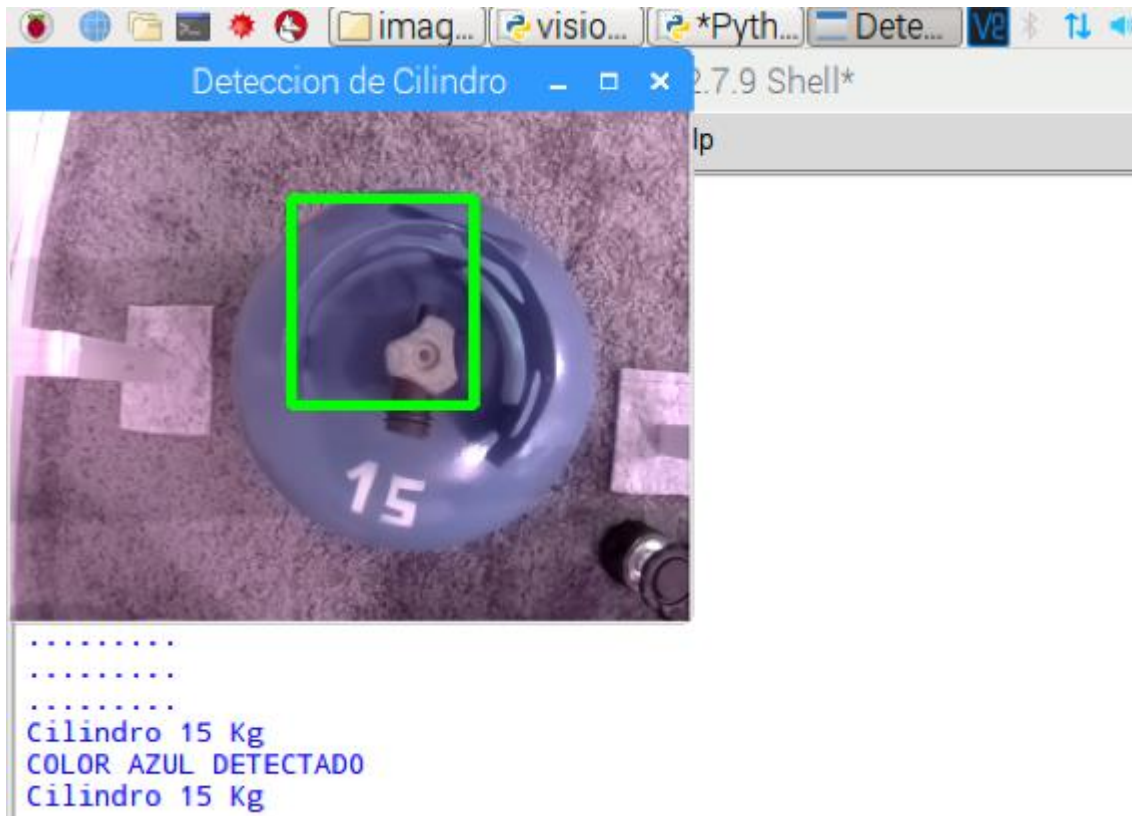
Figura 51. Detección de peso marcado y color de cilindro de gas
