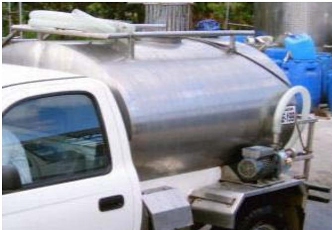
Tanque isotérmico de acero inoxidable el cual permitirá transportar la leche de diferentes fincas hacia la planta. Capacidad 1500 litro para transportar leche. Precio \$10000.
