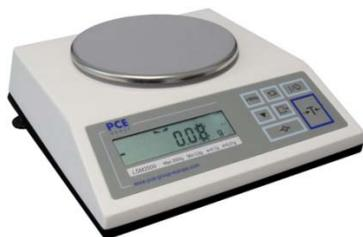
Balanza de mesa verificable. Es utilizada para medir el peso razonable que deber tener cada queso. Ajusta la precisión por medio de un peso externo. Indicador de capacidad. Pantalla digital. Precio \$ 120.
