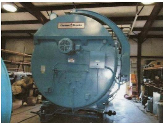
Caldero cleaver brooks de 500hp gas, 100% operativo. Sirve para calentar agua que será utilizada en el proceso de pasteurización. Precio \$5000.
