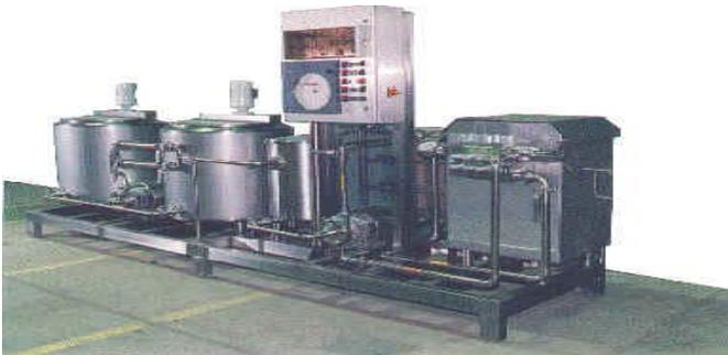
Este equipo está compuesto por un tanque balanceador, cuya función es receptor la leche que posteriormente va a ser pasteurizada. El pasteurizador es un equipo de placas totalmente hermético, cumple con la doble función de pasteurizar y enfriar la leche para su envasado. Permite un caudal aproximado de 300 lt/h, la
