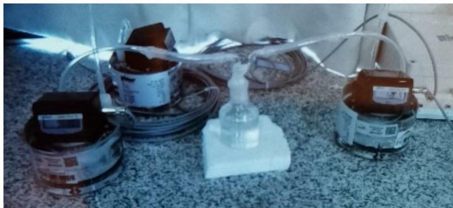
Figura 18. Sistema de cuantificación de metano en el biogás.
