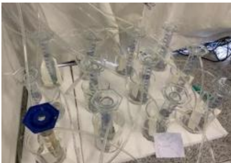
Figura 16. Equipo para medir metano mediante desplazamiento volumétrico.
