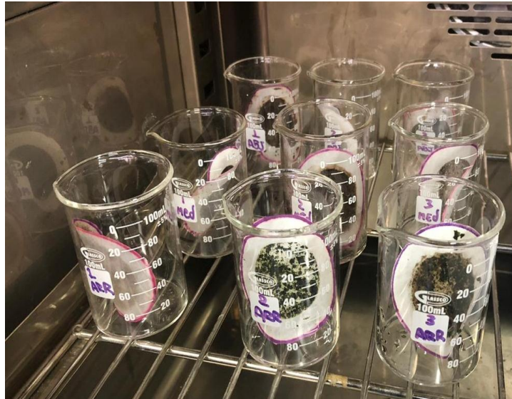
Figura 13. Ingreso de las muestras a la estufa tras la obtención del peso húmedo.
