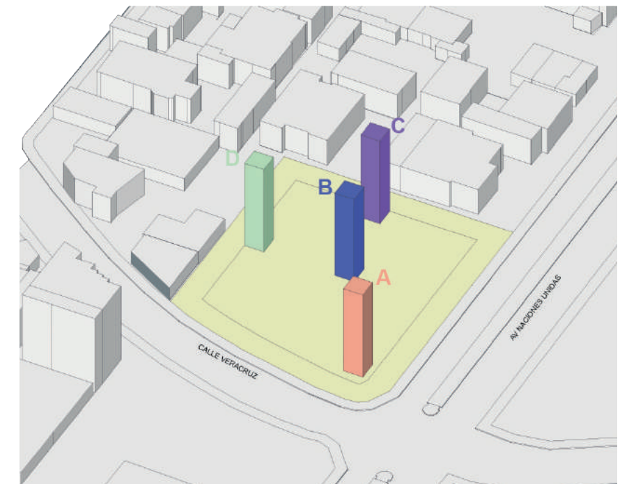
Figura 107. Punto fijo de circulación vertical, 4 posibilidades.
