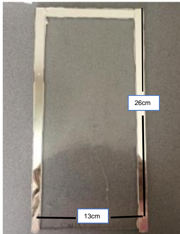
Figura 17. Elaboración de molde en placas de vidrio de 26 x13 cm.
