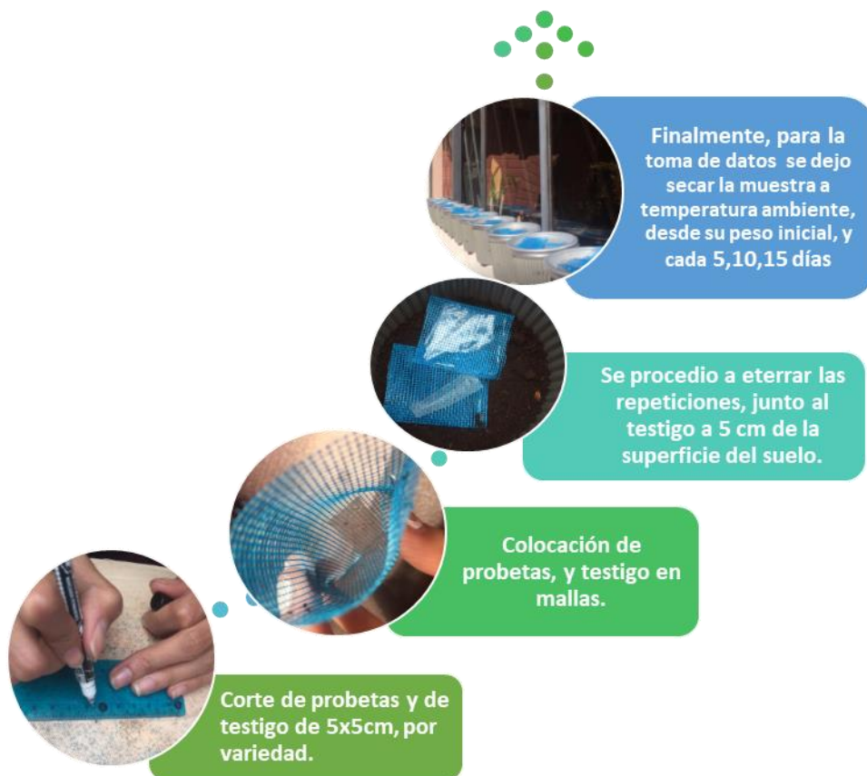
Figura 19. Diagrama de flujo del proceso de biodegradabilidad de la biopelícula por variedad.
