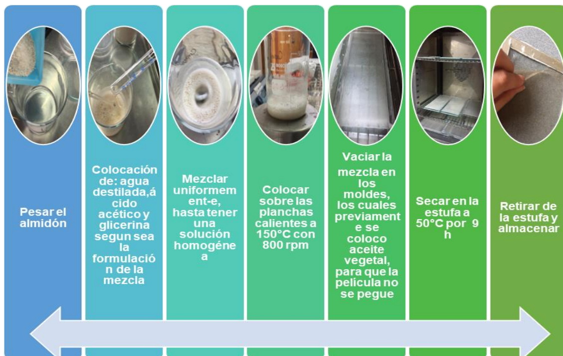
Figura 18. Diagrama de flujo del proceso de obtención de biopelícula.
