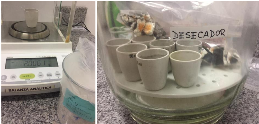
Figura 15. Análisis de humedad por el método AOAC por variedad (superchola y capiro).
