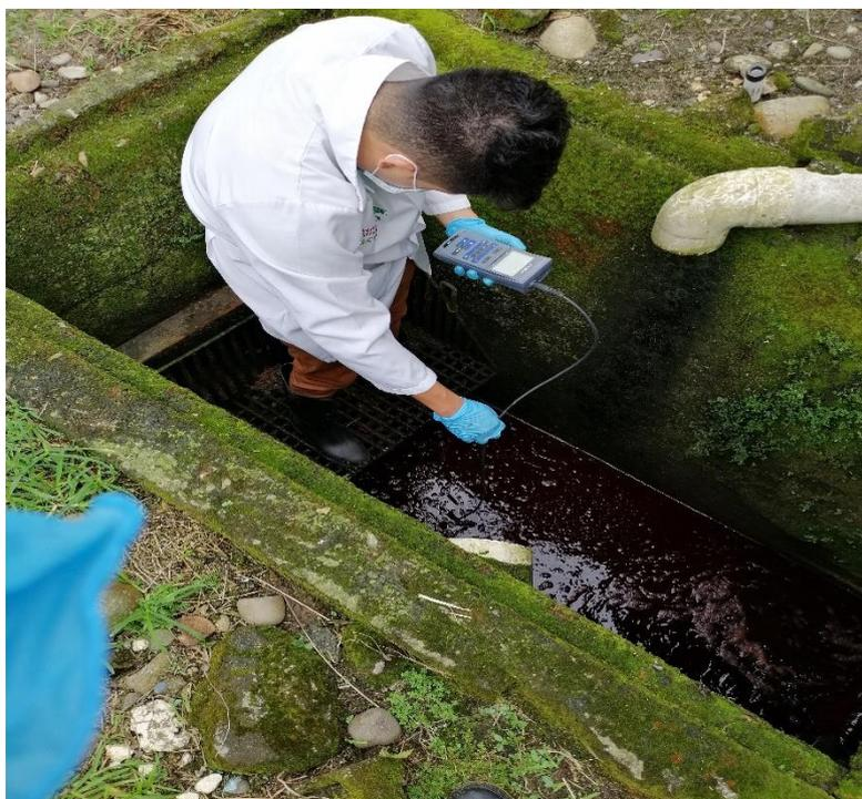
Anexo 22. Medición de DBO mediante equipo de oxitop.
