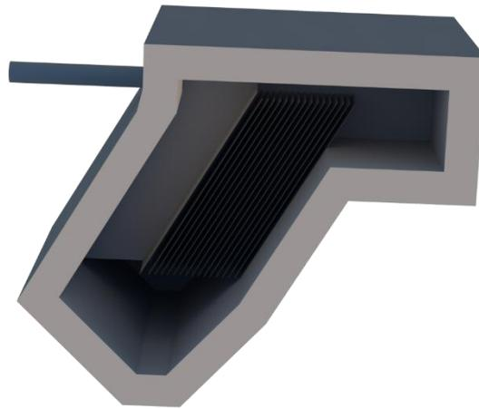
Figura 9. Esquema sedimentador tipo lamella.
