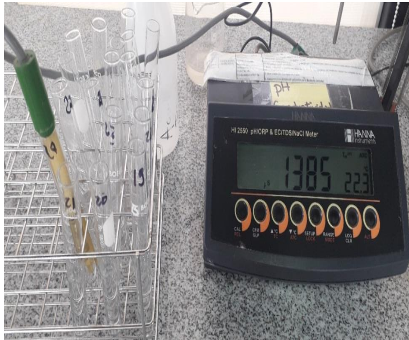
Figura 29. Medición de la conductividad eléctrica.
