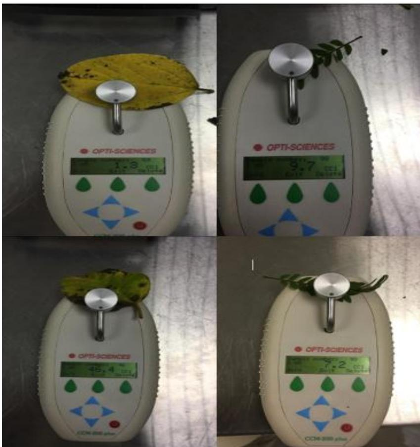
Figura 7. Medición de clorofila con el equipo medidor
