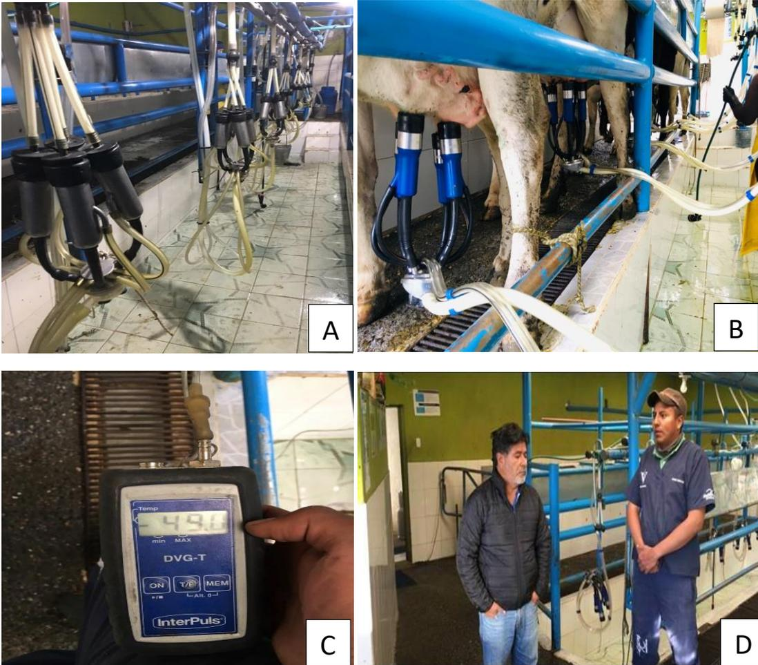
A) Pezoneras convencionales. B) Pezoneras triangulares ventiladas. C) Calibración de la máquina de ordeño. D) Instalación a cargo del técnico de la empresa.
