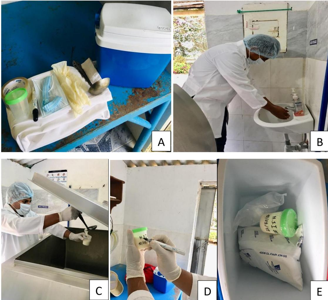
A) Materiales. B) Lavado y desinfección de manos. C) Toma de muestra del tanque de enfriamiento. D) Rotulado de la muestra. E) Refrigeración y envío de muestra.
