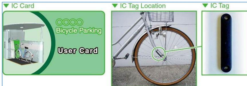
Figura 4. Chip identificador sistema EcoCycle.
