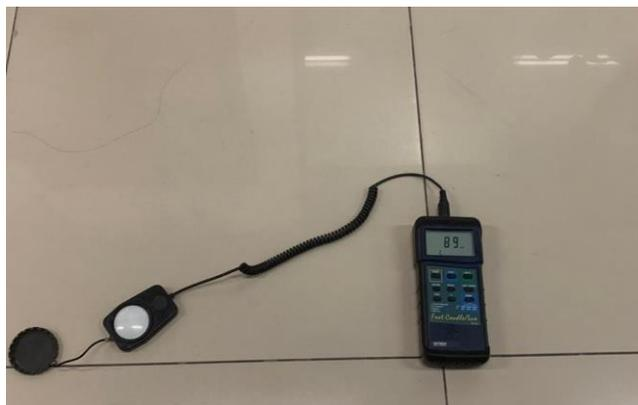
*Figura 25.* Medición de los puntos de iluminación en la planta baja.
