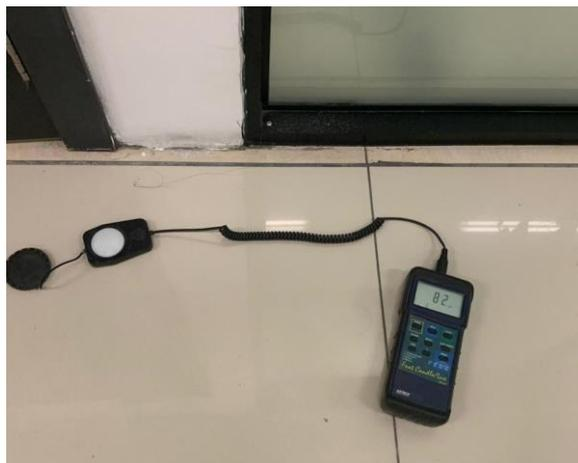
*Figura 24.* Medición de los puntos de iluminación en la planta baja.
