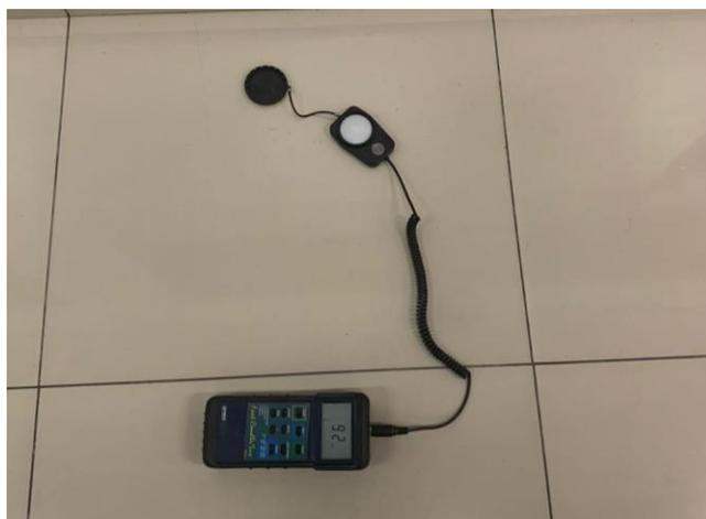
*Figura 26.* Medición de los puntos de iluminación en la planta baja.
