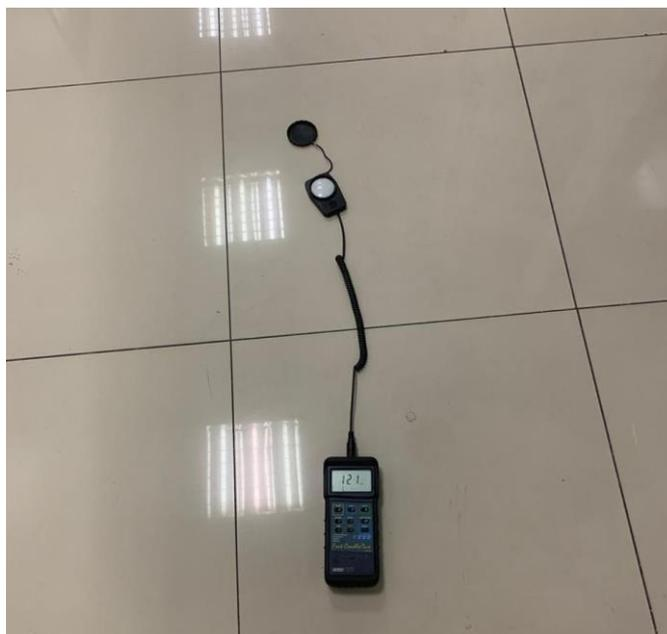
*Figura 28.* Medición de iluminación en la planta alta.
