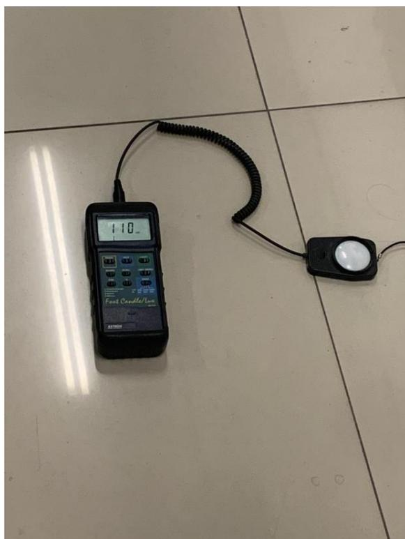
*Figura 19.* Medición en los puntos de iluminación en el subsuelo (pasillo).
