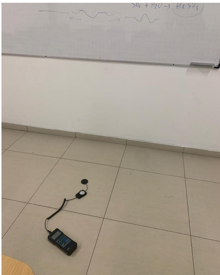
Figura 20. Medición de los puntos de iluminación en el subsuelo (aulas).
