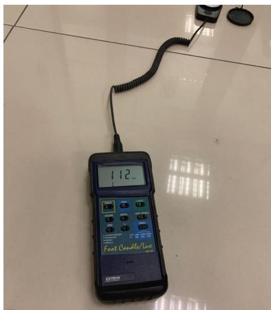
Figura 30. Medición de iluminación en la planta alta.
