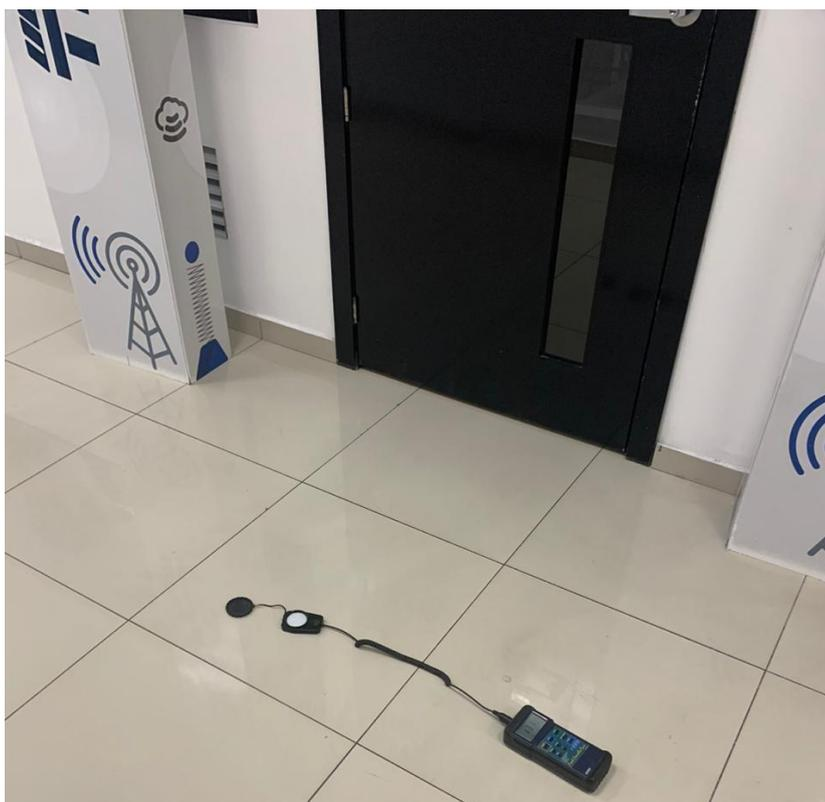
Figura 29. Medición de iluminación en la planta alta.
