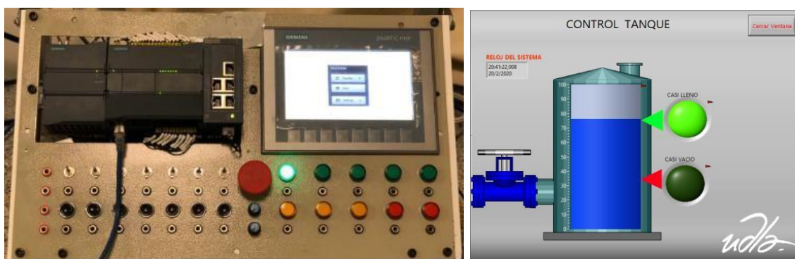
Figura 93. Tanque alarmado por condición casi lleno.
