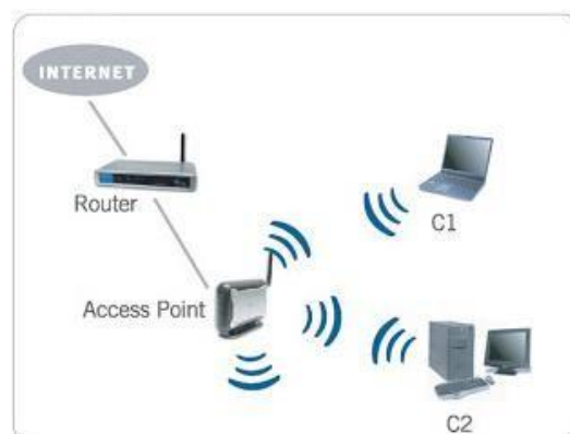
Figura 2. Bosquejo del funcionamiento de un router inalámbrico. Tomado de (REDES I, 2012).
