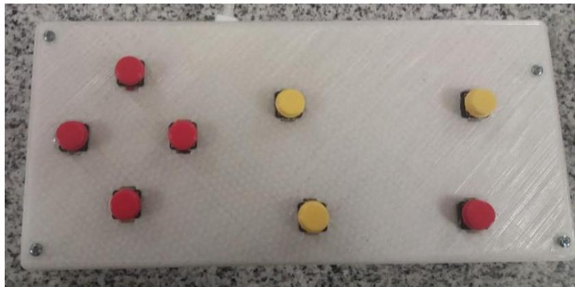
*Figura 21:* Tapa del prototipo con pulsadores ubicados.
