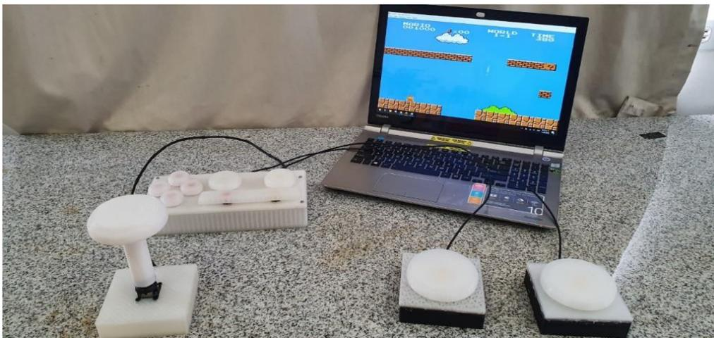
*Figura 26:* Prototipo de control de videojuegos implementado.
