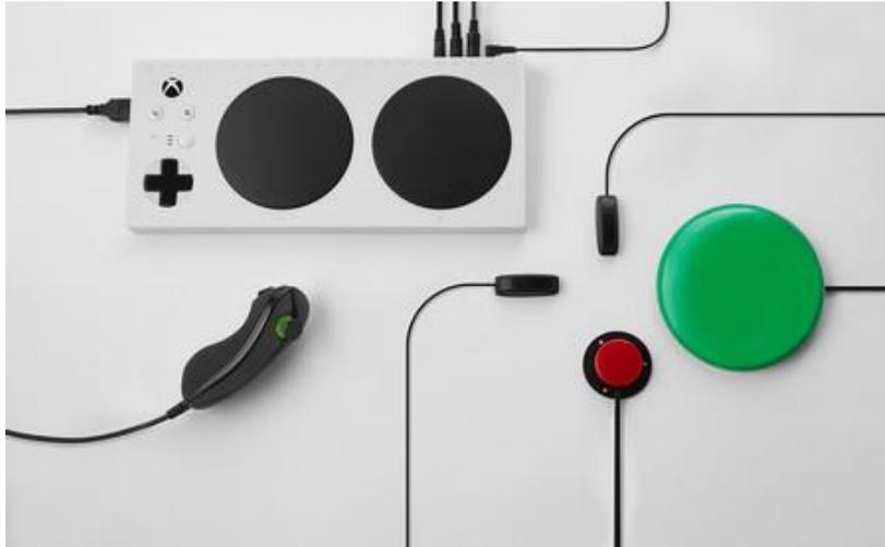
*Figura 8: Xbox Adaptive Controller mando principal y dispositivos externos. Tomado de (Microsoft, s.f.)*
