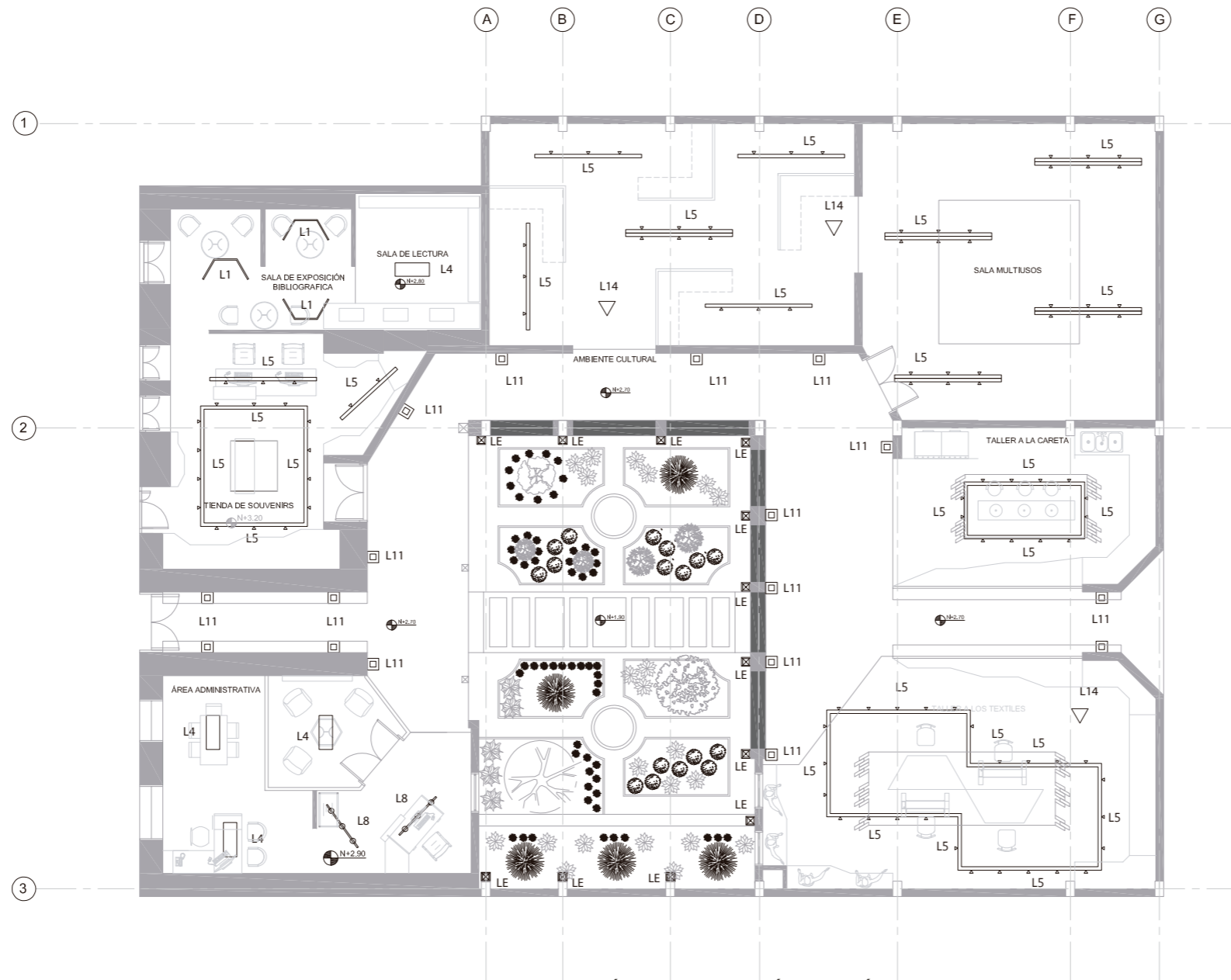
PLANTA DE SIMBOLOGÍA DE ILUMINACIÓN SECCIÓN 1 esc 1-150
