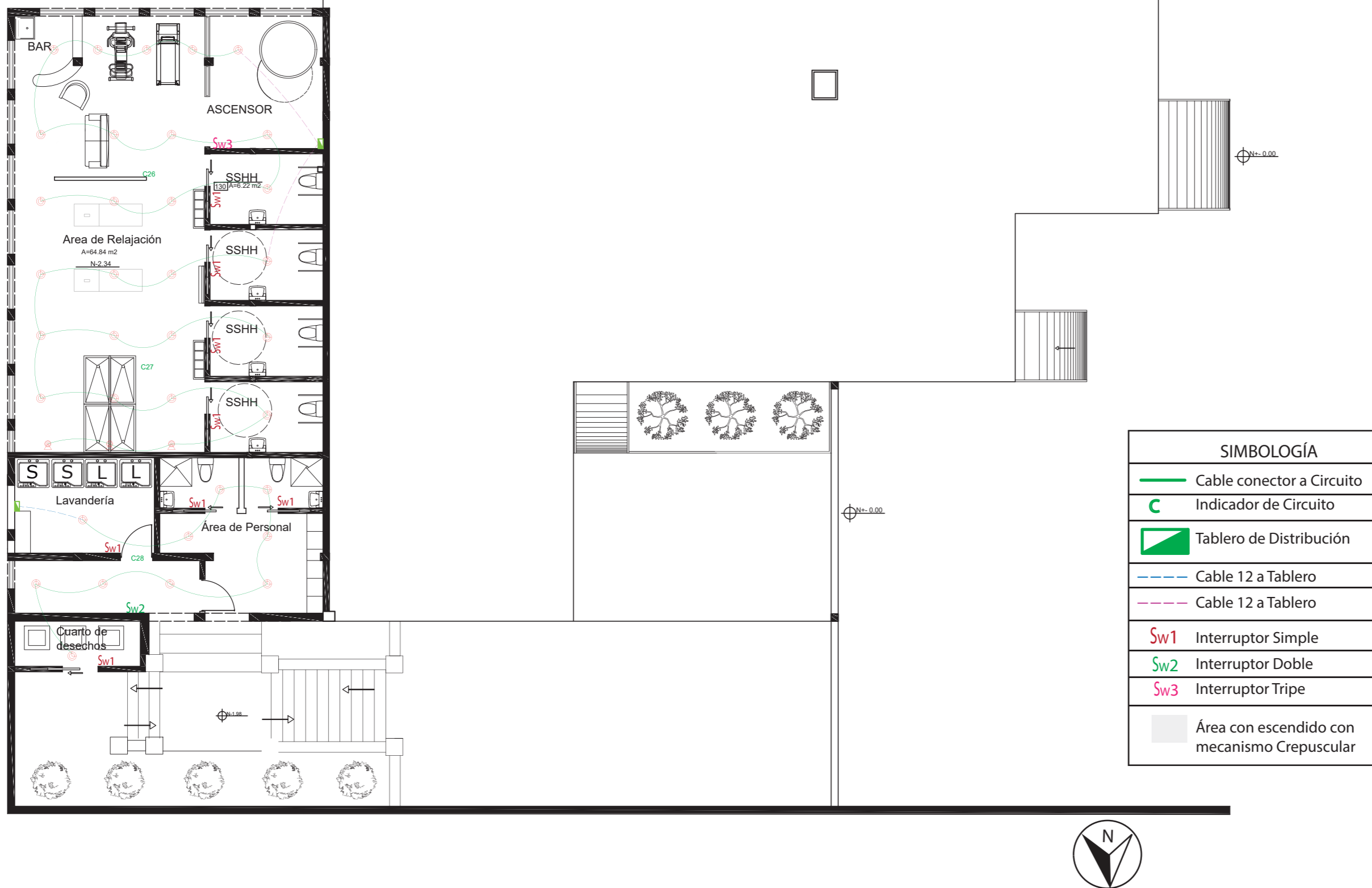
Planta Subsuelo- Conexiones Eléctricas Fuerza Esc. 1.120
