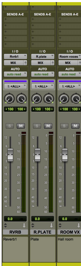
Figura 52. Canales auxiliares en los que se aplicaron los plugins de reverbs para la mezcla.
