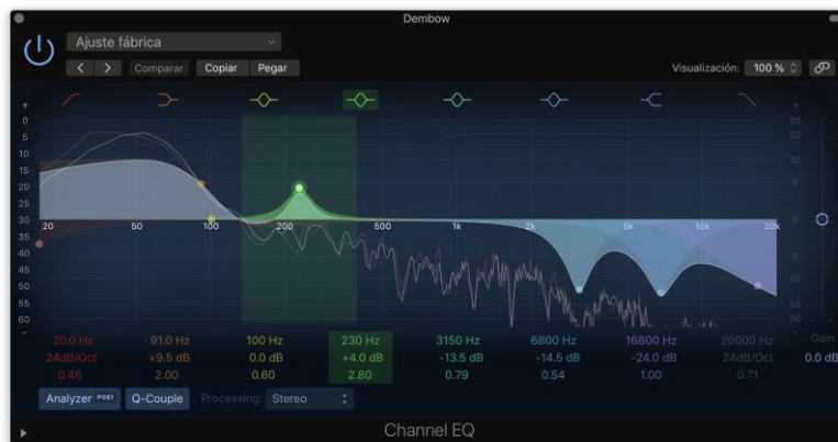
Figura 30. Aplicación de ecualización paramétrica en tema “Volvete a ver” dembow 2 extraído de Logic
