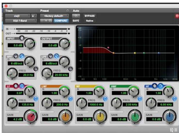
Figura 7. Ecuador frecuencia baja. Extraída de Protools.
