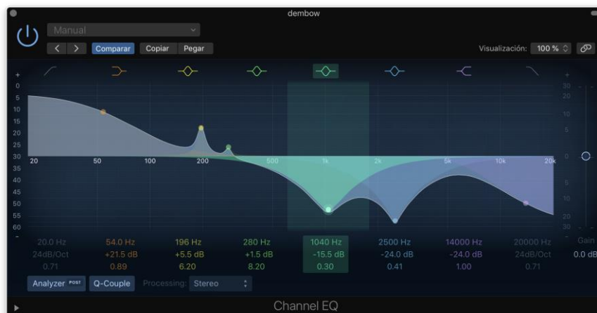
Figura 27. Aplicación de ecualización paramétrica en tema “De nuevo” Dembow 1 extraído de Logic
