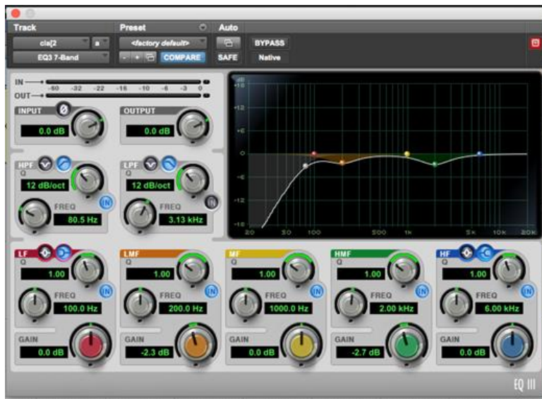
Figura 3. Ecuador paramétrico. Extraído de Protools.
