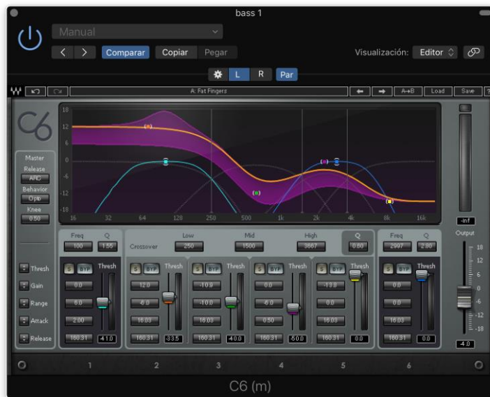
Figura 33. Aplicación de compresión en tema “De nuevo” línea de bajo extraído de waves
