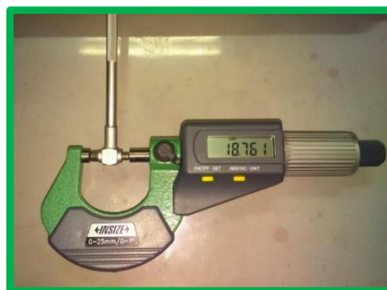
Figura 102. Medición de galga telescópica con el micrómetro digital
