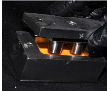
Figura 80. Colocación de la base de los muñones sobre la cubeta sin perforaciones y la silicona adición pesada. Primera fase de la impresión. Tiempo en boca de 3:30 minutos.
