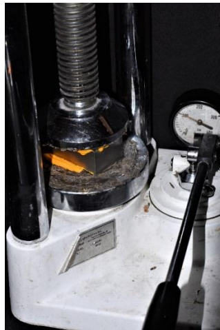
Figura 81. Prensado del modelo maestro con una presión constante hasta que polimeriza por 5:30 minutos
