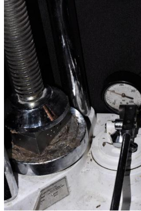
Figura 68. Colocación en la prensa hidráulica.
