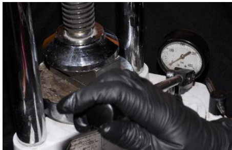
Figura 33. colocación en la prensa hidráulica.
