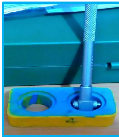
Figura 99. Medición diámetro interior con la galga telescópica en la muestra de silicona de adición.
