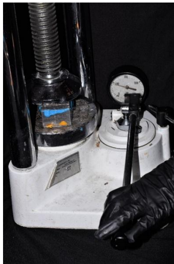
Figura 87. Segunda impresión con una presión constante en la prensa hidráulica, polimeriza en 5:30 minutos.
