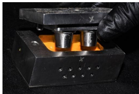
Figura 67. Colocación de la masa de silicona de adición en la cubeta con perforaciones y el patrón de acero inoxidable.
