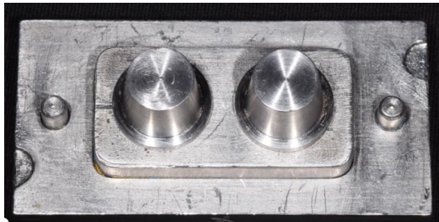
Figura 24. Representación de los muñones en el modelo de acero inoxidable. Vista Superior.
