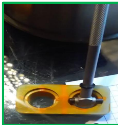
Figura 100. Medición diámetro interior con la galga Telescópica en la muestra de la silicona de condensación cubeta lisa.
