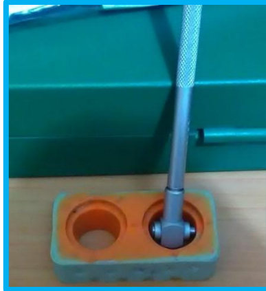
Figura 101. Medición diámetro interior con la galga Telescópica en la muestra de la silicona de condensación. Cubeta perforada
