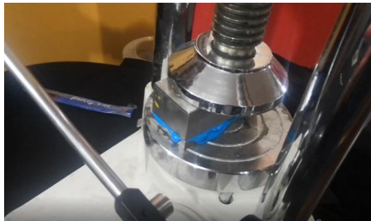
Figura 87. Segunda impresión con una presión constante en la prensa hidráulica, polimeriza en 5:30 minutos.
