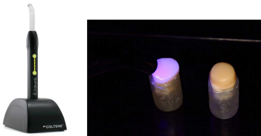
Figura 27. Aplicación de luz con una intensidad de 1600 mw/cm 2
