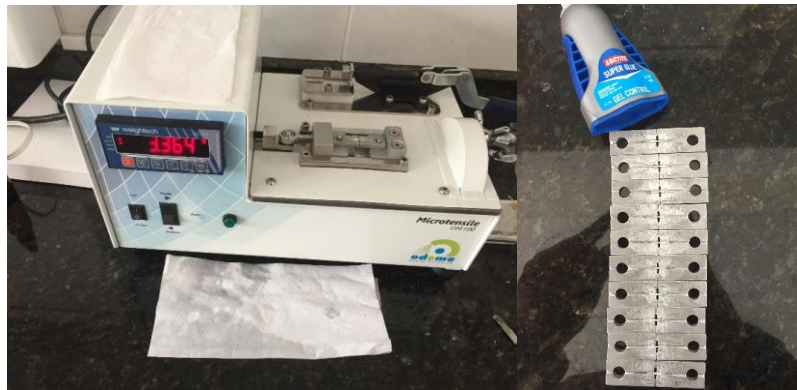
Figura 33. Máquina de tracción de la UDLA (WEIGHTECH-WT21/MICROTENSILE OM-100) y platinas donde se colocan las vigas cortados
