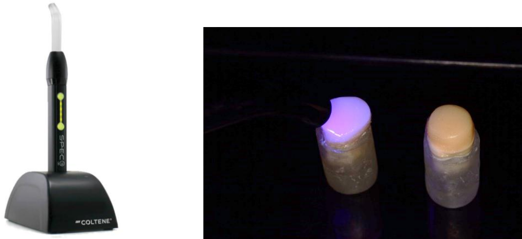
Figura 20. Aplicación de luz con una intensidad de 1600 mw/cm 2
