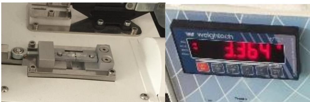
Figura 34. Platina de aluminio en la máquina de microtracción, y fuerza a la que se produjo la fractura
