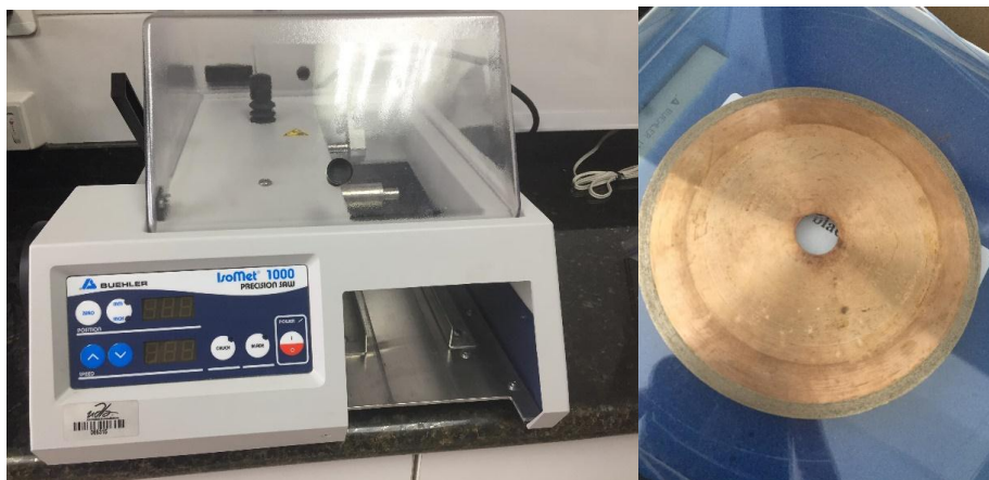
Figura 28. Máquina de corte (BUEHLER / ISOMET 1000-PRECISION SAW) y sierra de corte de baja velocidad.
