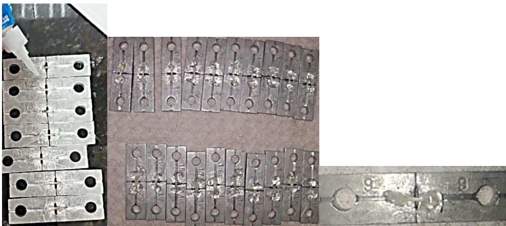
Figura 25. Sujeción de la muestra en la galga metálica con Cianocrilato en gel.
