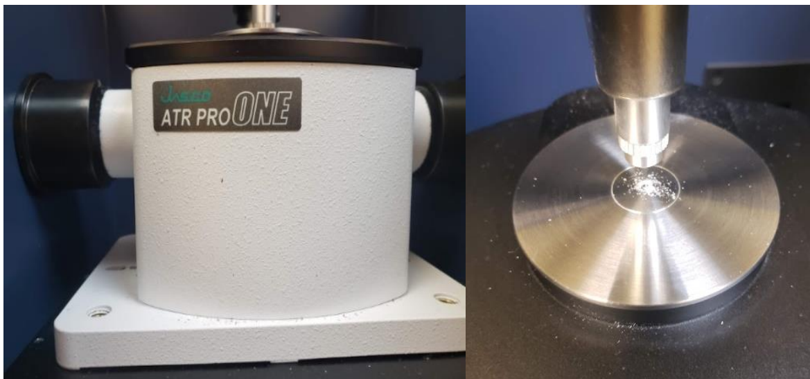
Figura 4. Cristal de ATR sobre el cual se colocan las muestras.
