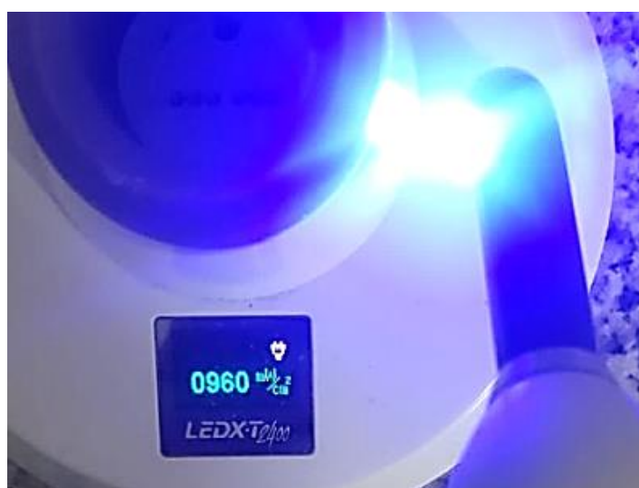
Figura 6. Calibración de salida con radiómetro
