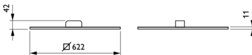
Figura 23. Plano de Dimensiones Luminaria CoreLine Panel
