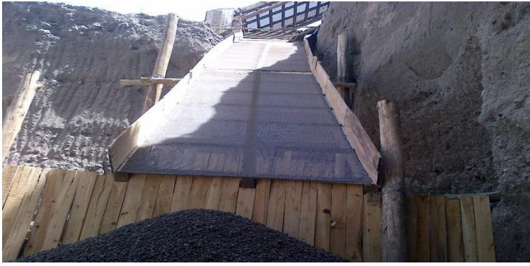
Figura 6. Vista Frontal de Zarandas para el Cribado Artesanal de Material.
