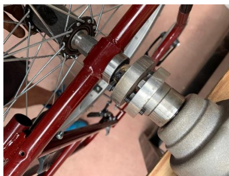
Figura 43. Acople del matrimonio con los motores.
