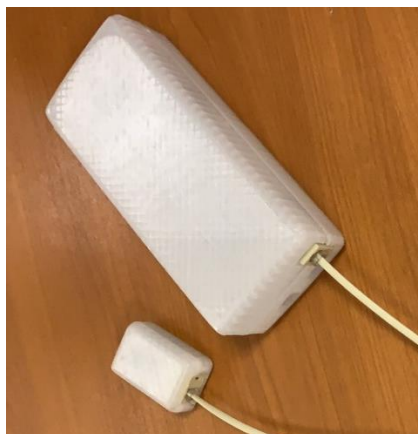
Figura 28. Elementos separados y enlazados con el conector RJ-11.
