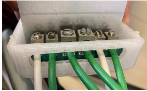
Figura 47. Espacio limado para ingreso de los cables del motor y batería.
