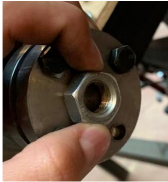
Figura 41. Soldadura de la tuerca en el matrimonio.
