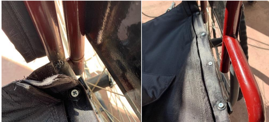
Figura 45. Suelda de los tubos que sostienen al asiento.
