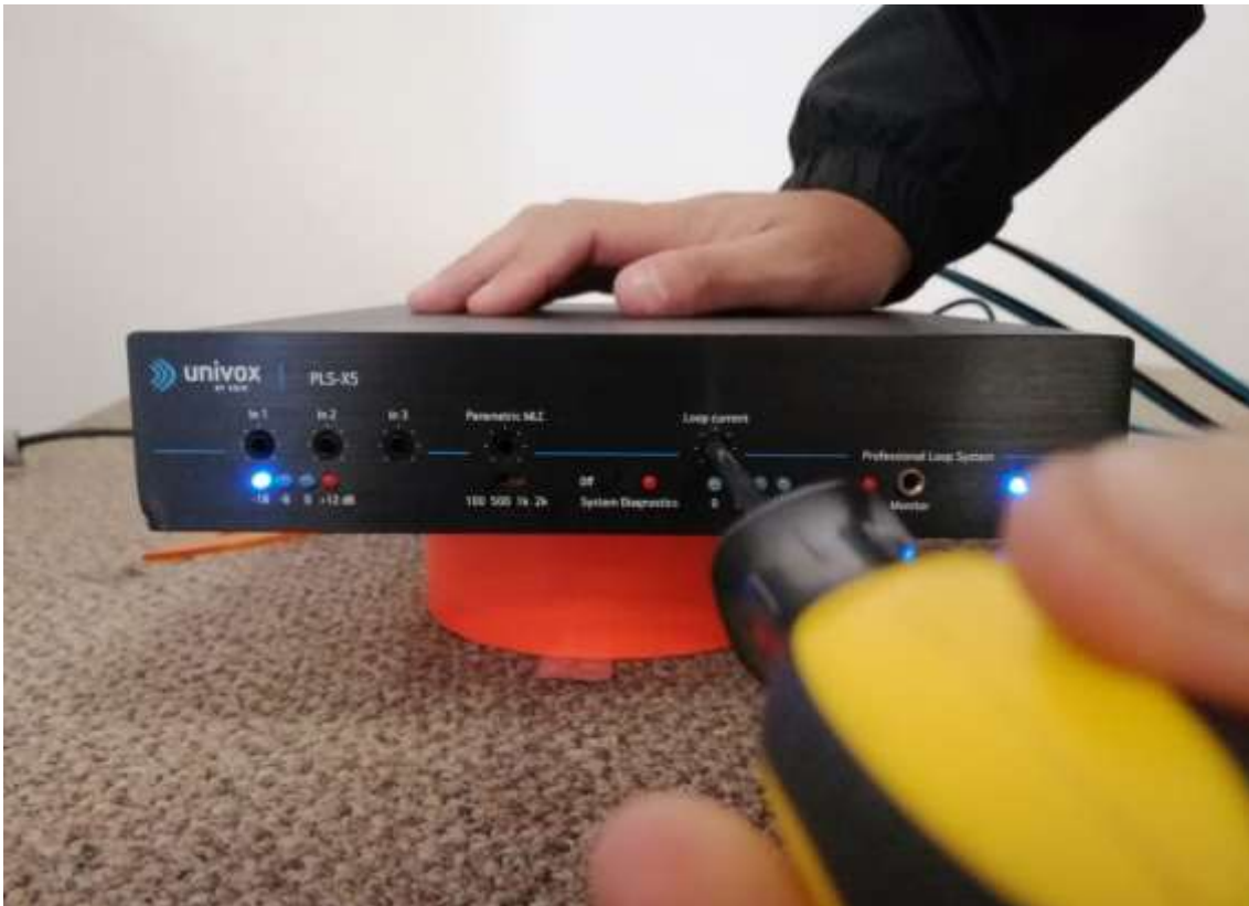
Configuración de nivel de corriente para el sistema de bucle inductivo.
