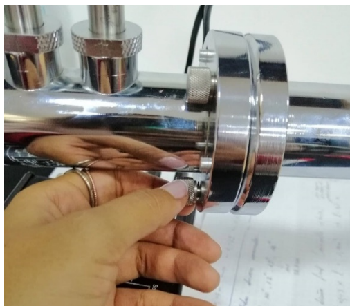
Figura 36. Soporte de muestras colocado en el tubo de impedancia.
