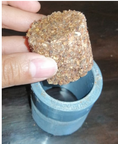
Figura 25. Desmontaje de muestra del molde.
