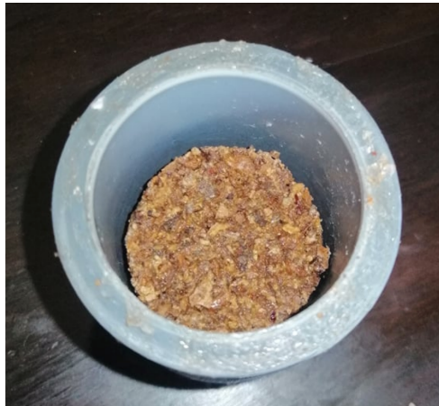
Figura 24. Mezcla de cacao con aglutinante dentro del molde
