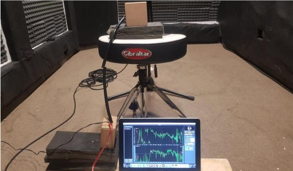
Figura 40. Medición de la respuesta en frecuencia con SMAART.
