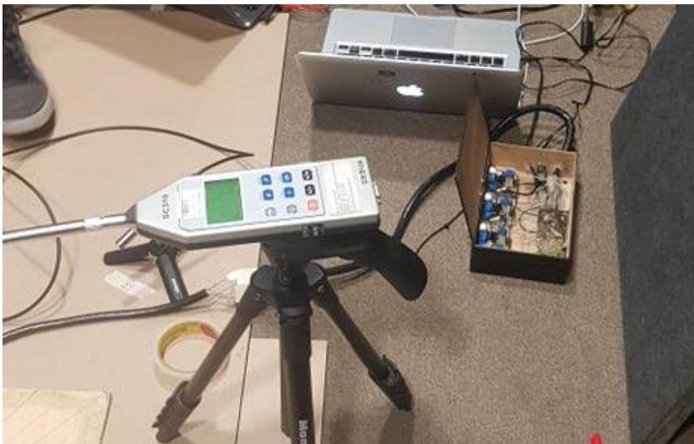
*Figura 42.* Medición de la respuesta de frecuencia de la fuente utilizando MATLAB y sonómetro CESVA SC310.
