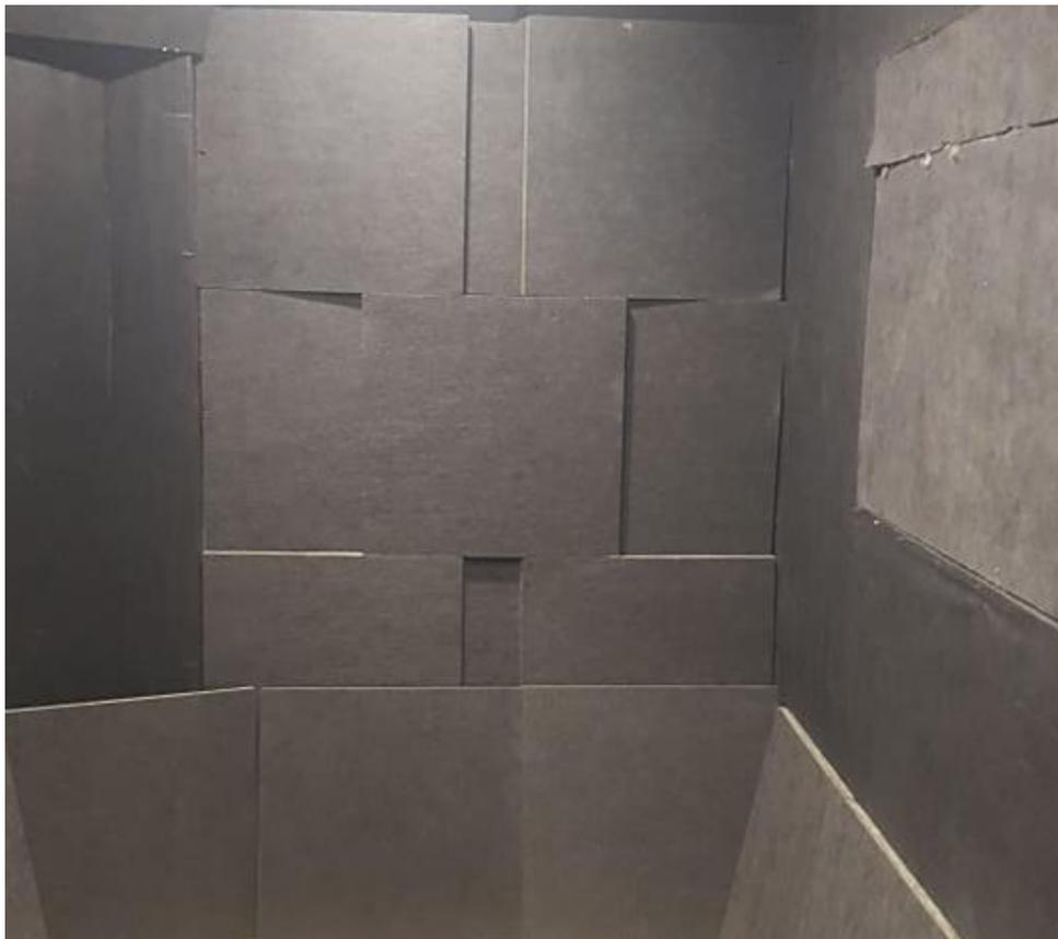
*Figura 27.* Sala de ensayo acondicionada con material de lana de roca.
