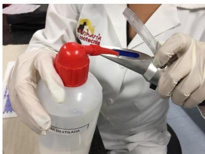
Figura 16. Calibración del refractómetro con agua destilada.
