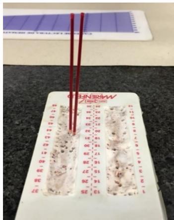
Figura 13. Capilares para centrifugación.
