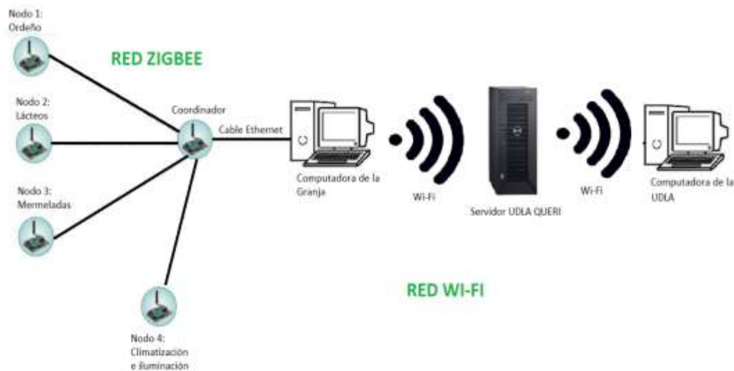
Figura 64. Red de sensores Zigbee con el esquema de como enviar los datos a la UDLA.
