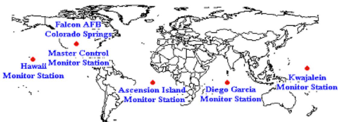
Figura 1. Situación de las estaciones monitoras y de la estación de control maestra.
