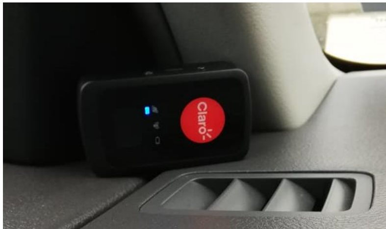
Figura 23. Instalación de un GPS en un vehículo.
