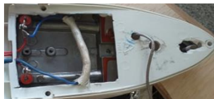
Figura 18. Resistencia y Termocupla
