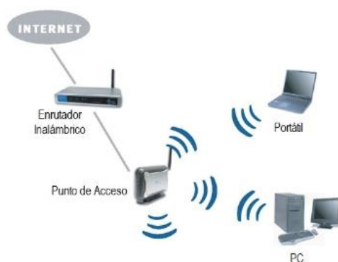
Figura 7. Uso de un AP en una red inalámbrica.
