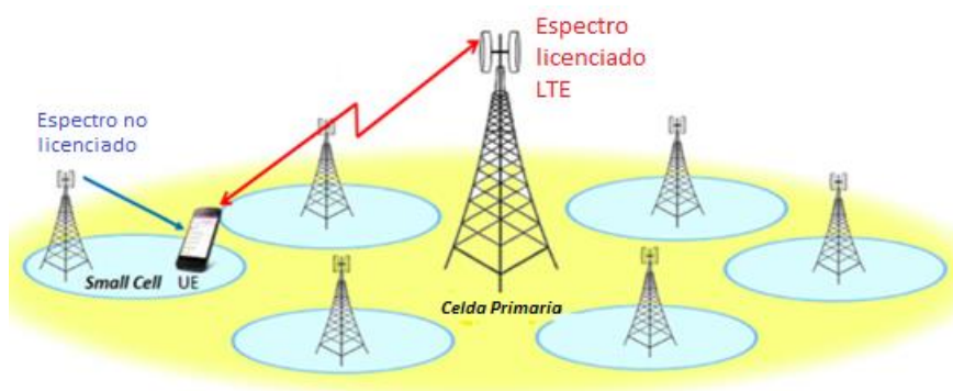
Figura 23. Principio de funcionamiento de LTE-U en términos de espectro.
