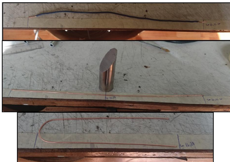
Figura 41. Construcción de acople de impedancias, cable 12 AWG.
