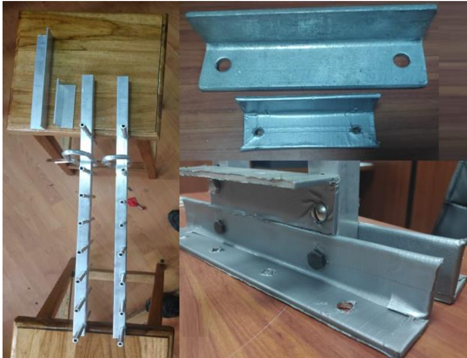
Figura 38. Soporte de antenas.
