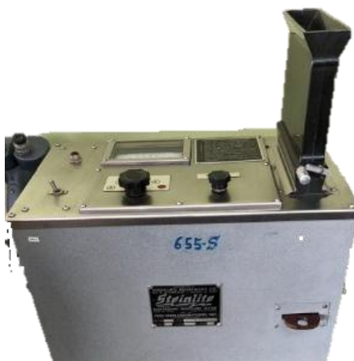
Figura 3. Medidor de humedad Stainlite Moisture Tester - Impedancia.
