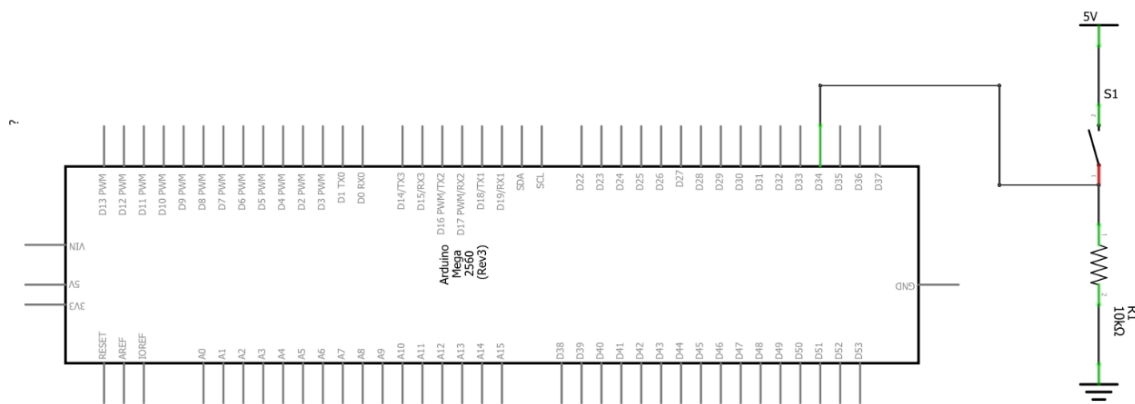
Figura 28. Circuito eléctrico para la implementación del botón.
