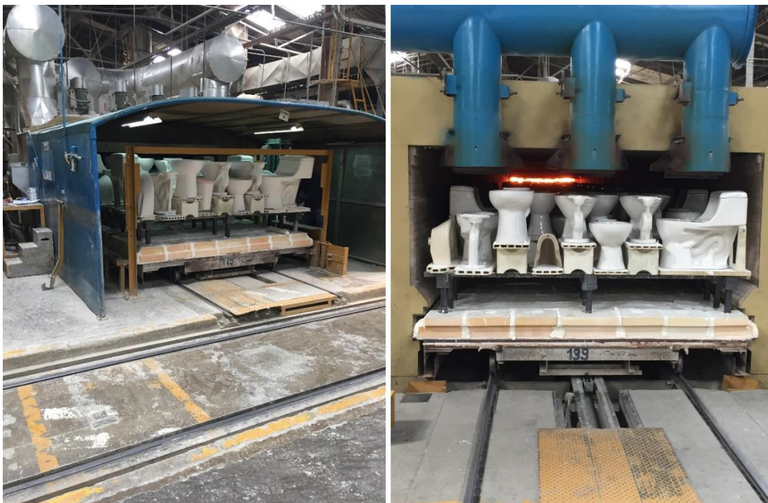
Figura 32. Imagen de la entrada y de la salida del horno 3
