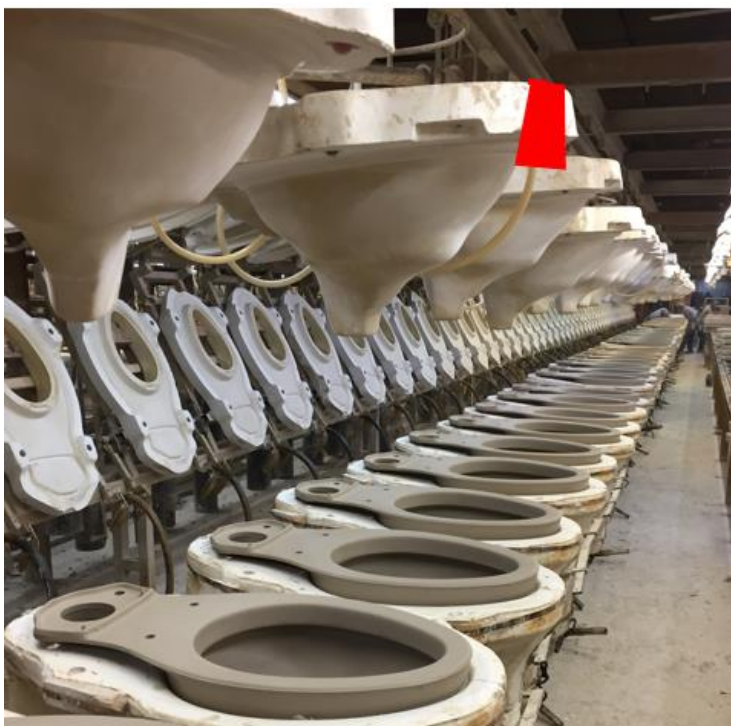
Figura 72. Ejemplo de tarjeta Kanban para mantenimiento de molde
