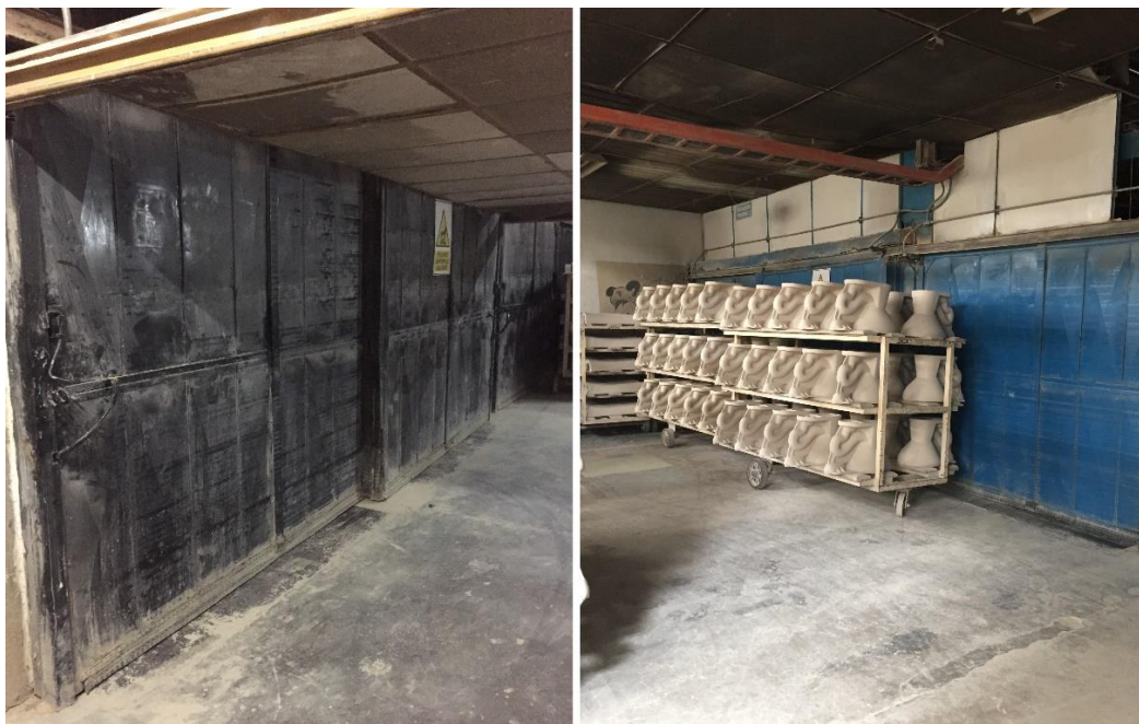
Figura 25. Imagen de la entrada y salida de la cámara del proceso de Secado
