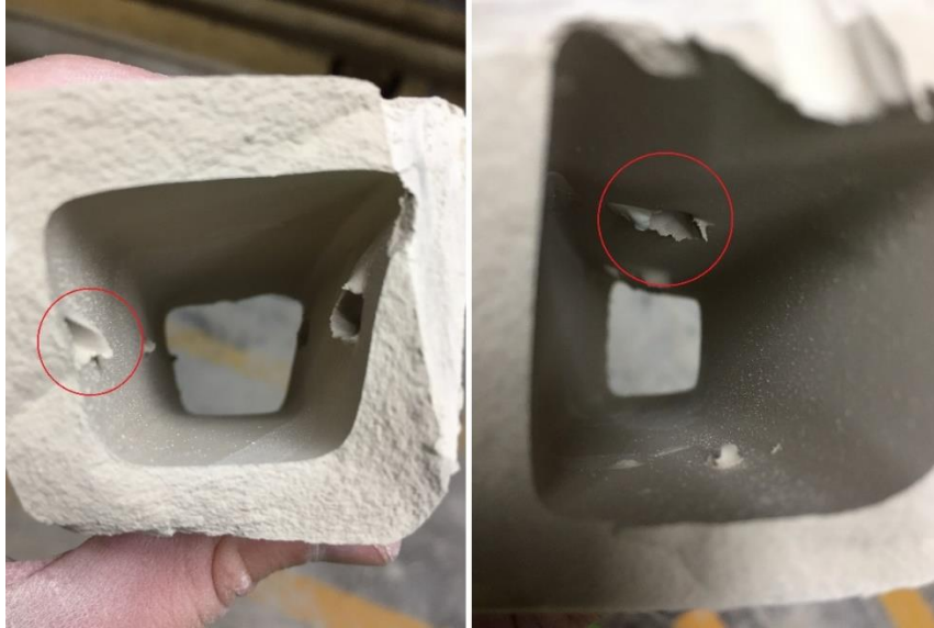
Figura 66. Defecto del sacabocados en perforaciones de anillo
