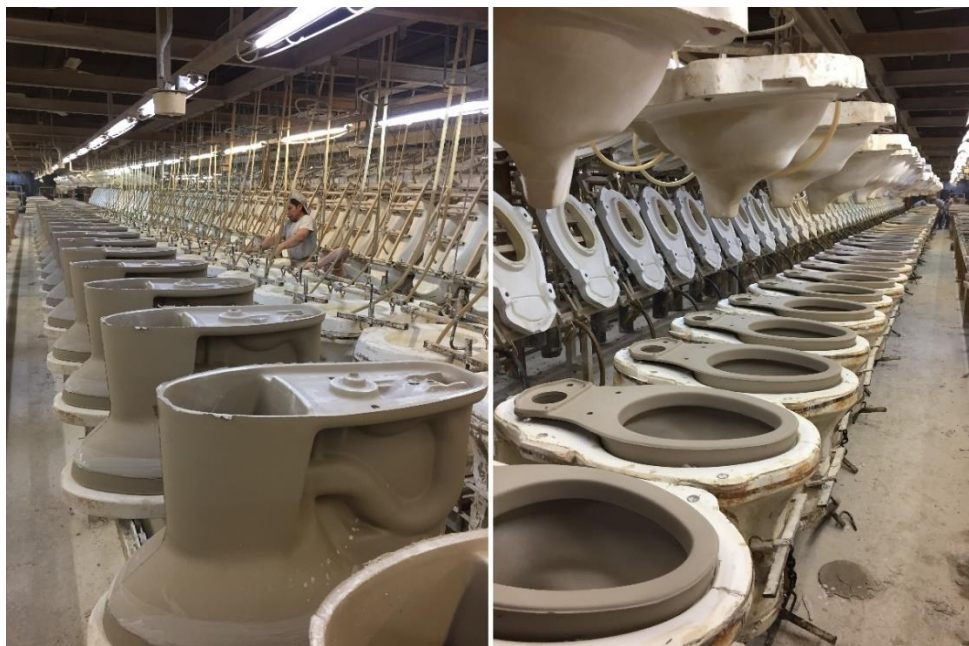
Figura 22. Imagen del proceso de vaciado
