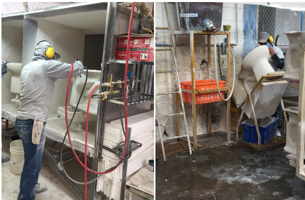
Figura 29. Proceso de esmaltado
