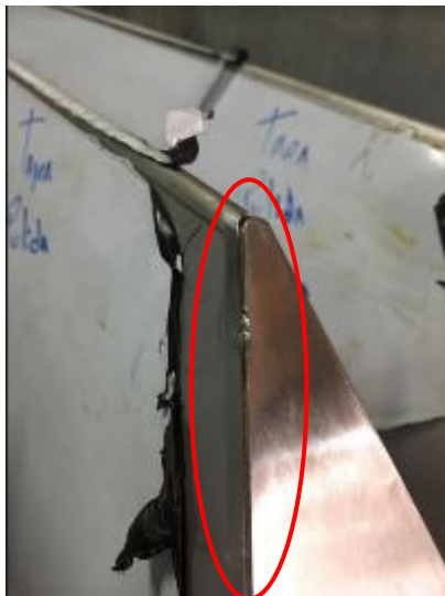
Figura 39. Errores de suelda en las tapas de las costillas
