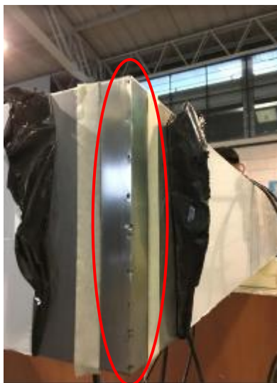
Figura 38. Errores de suelda en las esquinas del marco del techo
