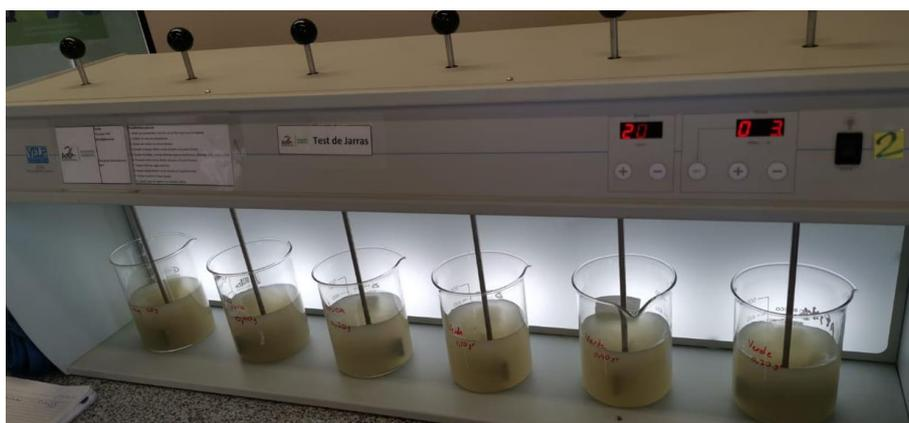
Figura 24. Prueba de dosificación en test de jarras.
