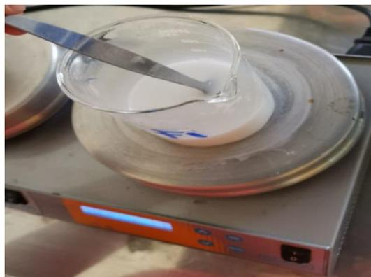
*Figura 23.* Proceso de gelificación en parrilla de calentamiento con agitación.
