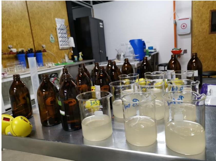
**Anexo 4.** Prueba de jarrar para el segundo diseño experimental.
