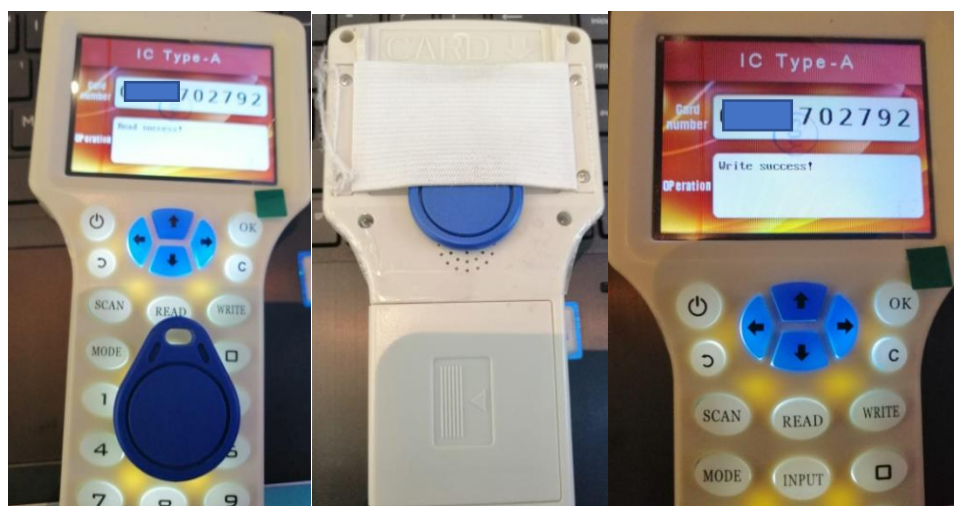
Figura 17. Escritura de tarjeta contactless a un tag.
