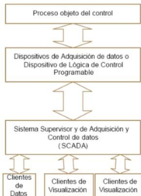
*Figura 2.* Representación esquemática de un sistema SCADA.
