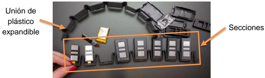
*Figura 16.* Secciones del MYO Armband.
