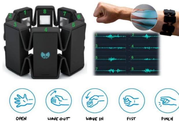
Figura 23. Gestos reconocidos por defecto en el MYO Armband.
