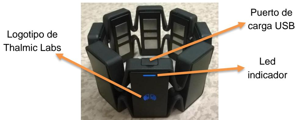
*Figura 18.* Indicadores y puerto de carga del MYO Armband.
