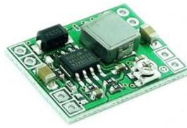
*Figura 29.* Convertidor Step-Down MP1584EN.
