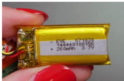
*Figura 17.* Batería del MYO Armband.
