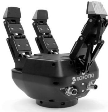
*Figura 1.* Mano robótica tipo “pinza”.
