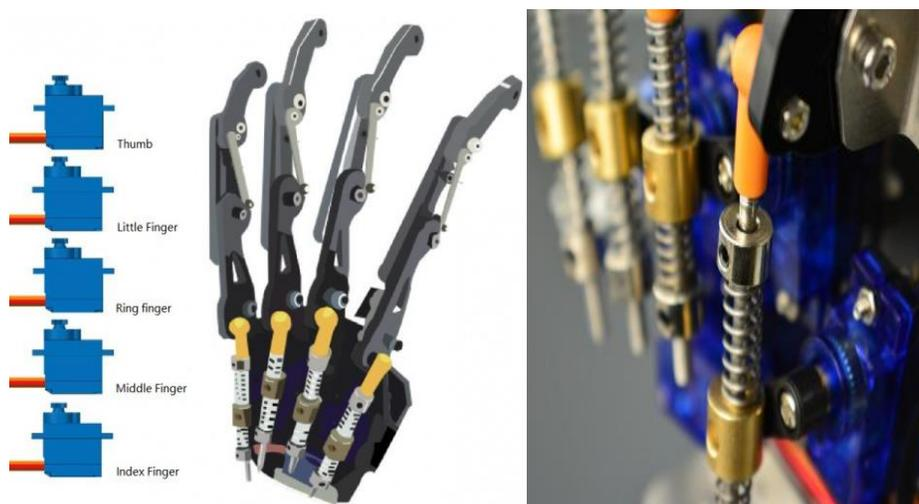
*Figura 9.* Mecanismo de resortes de la “Bionic Robot Hand (Right)”.
